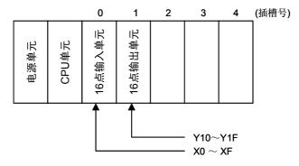
16 点外部输入继电器 X0 到 XF 分配给 0 号插槽中的 16 点输入单元, 16 点外部输出继电器 Y10 到 Y1F 分配给 1 号插槽中的 16 点输出单元。
