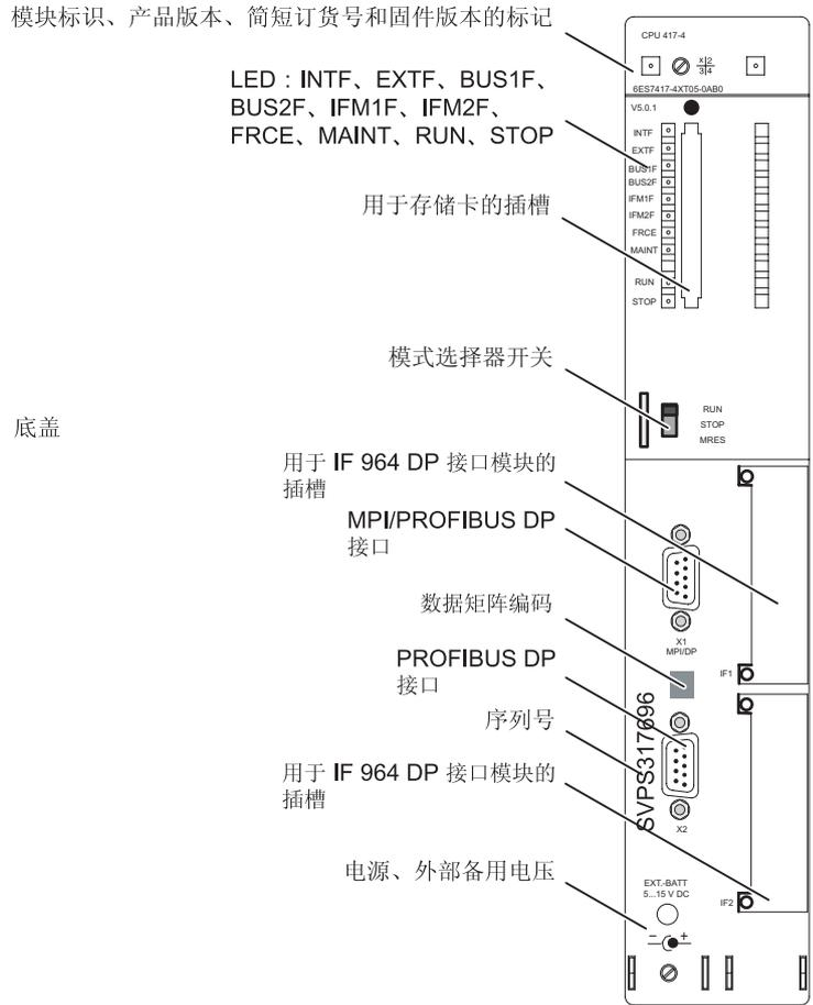
图片 2-5 CPU 417-4 上操作员控件和显示的布局
