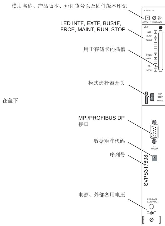
图片 2-1 CPU 412-1 上操作员控件和显示的布局
