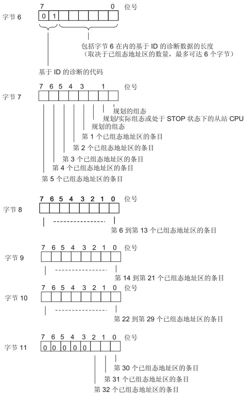
图片 5-4 CPU 41x 的 ID 相关诊断数据的结构
