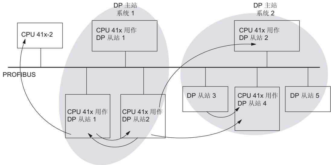
图片 5-7 使用 41x CPU 进行的直接数据交换
