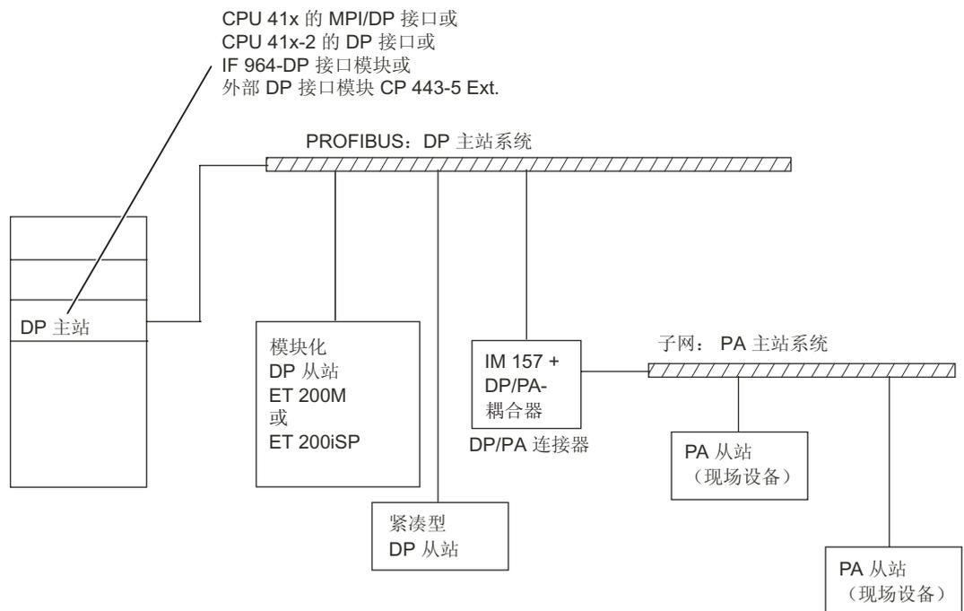
图片 3-2 概述：为实现在运行期间修改系统的系统结构
