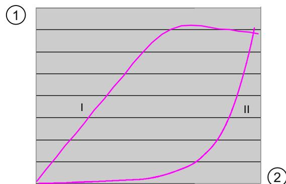
图片 4-5 通讯负载作为数据吞吐量和响应时间的函数（基本配置文件）
