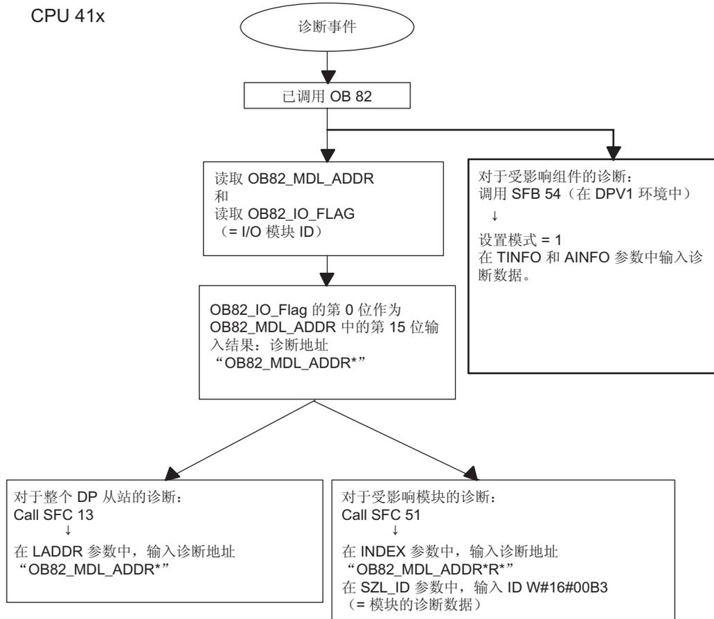
图片 5-1 用 CPU 41x 诊断
