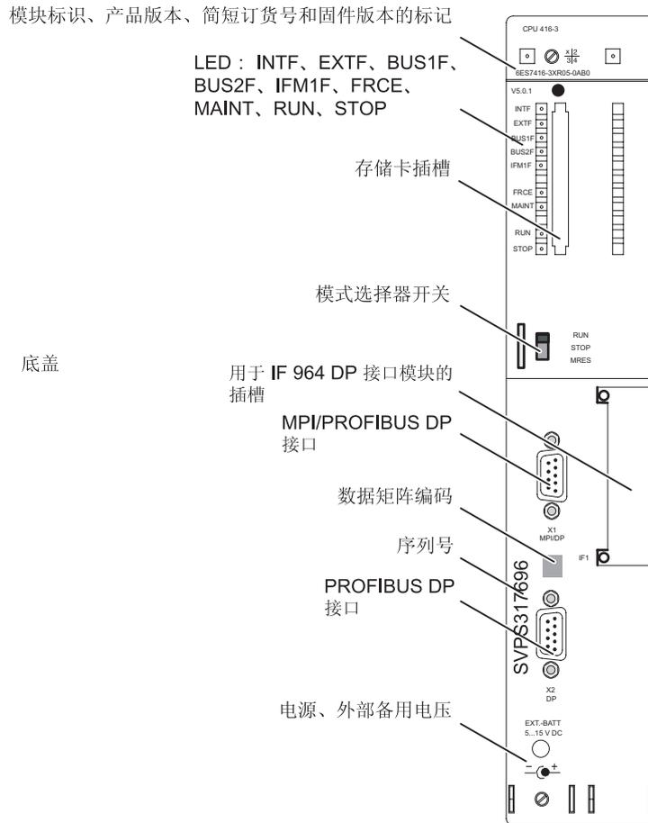
图片 2-3 CPU 41x-3 上操作员控件和显示的布局
