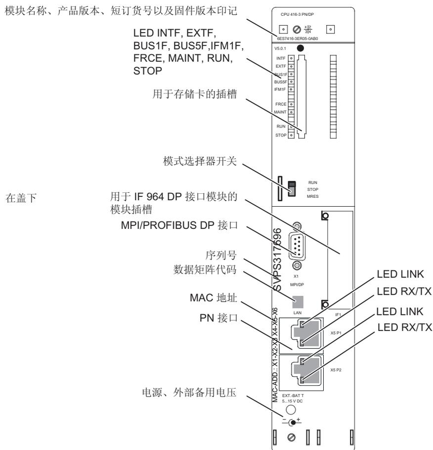
图片 2-4 CPU 41x-3PN/DP 上控件和显示的布局
