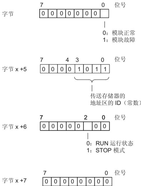
图片 5-6 用于诊断和硬件中断的字节 x + 4 到 x + 7
