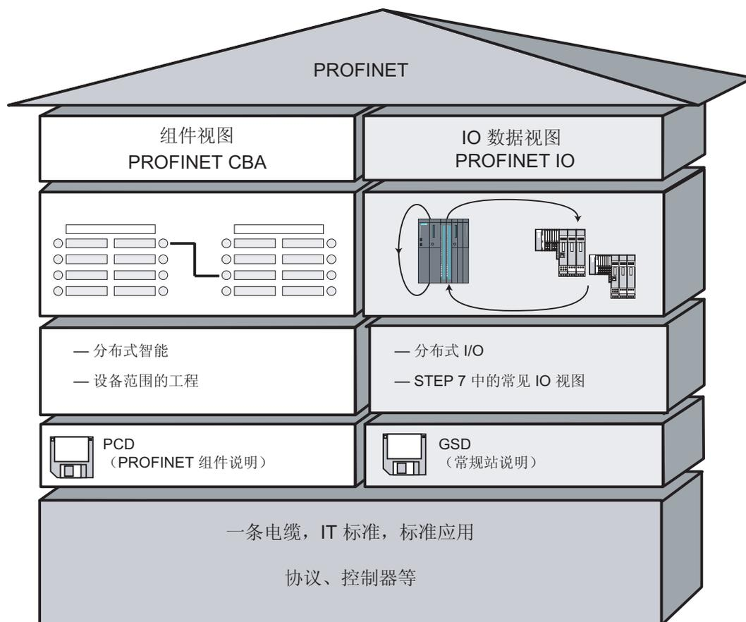
图片 6-1 PROFINET IO 和 PROFINET CBA
