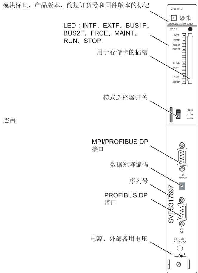
图片 2-2 CPU 41x-2 上操作员控件和显示的布局
