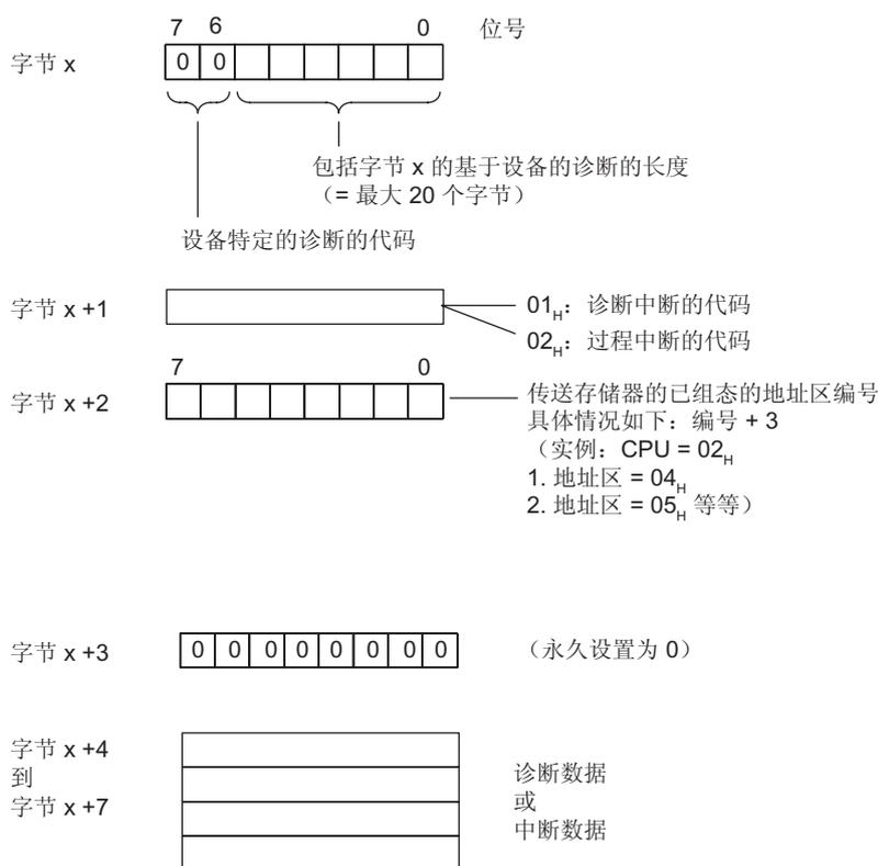
图片 5-5 设备相关的诊断信息的结构
