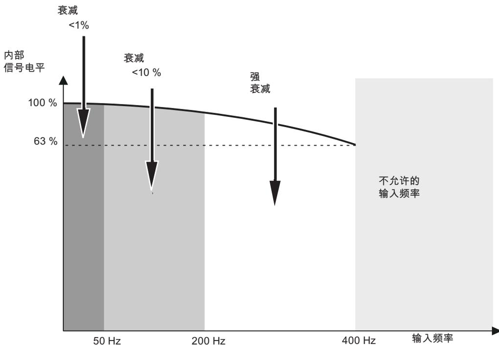
图 6-3 集成滤波器的低通特性
