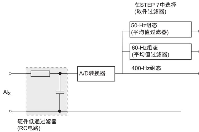
图 6-4 用 STEP 7 实现干扰抑制的原理
