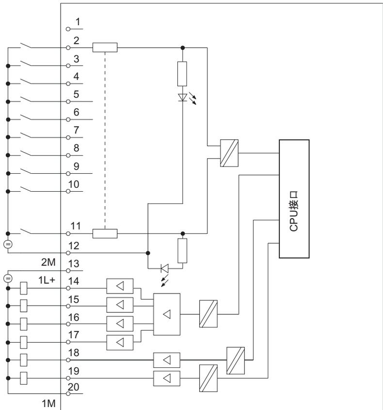
CPU 313C、CPU 313C-2 DP/PtP、CPU 314C-2 DP/PtP : DI/DO ( 连接器 X11 和 X12 )
