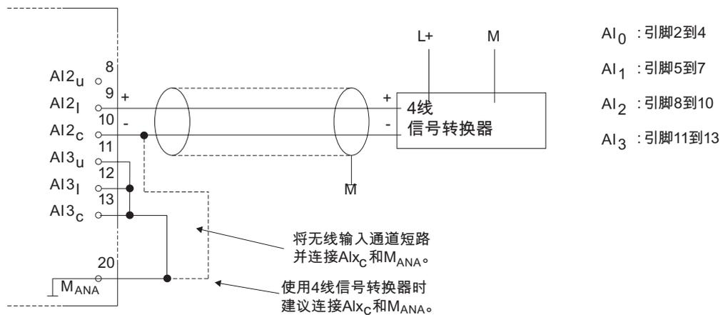
图 6-2 4 线测量传感器到 CPU 313C/314C-2 模拟电流/电压输入的连接
