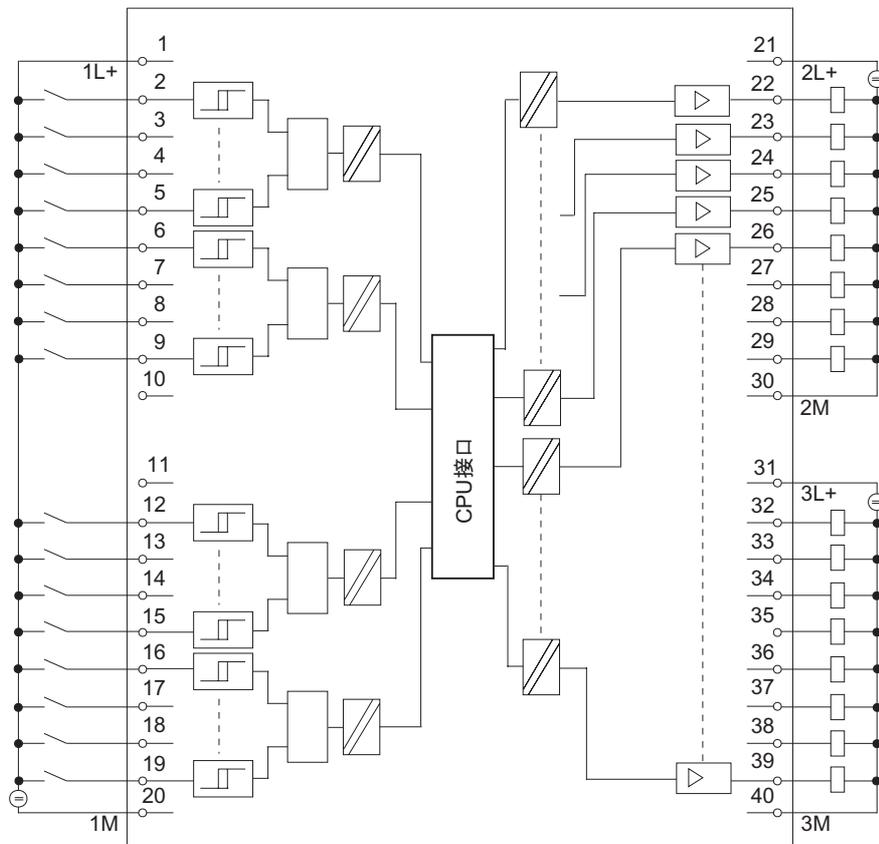
CPU 313C/314C-2 : 集成 AI/AO 和 DI ( 连接器 X11 ) 的引脚分配
