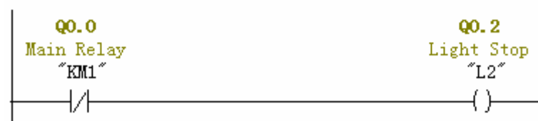
图 3: 电机启动控制电路 LAD 程序
