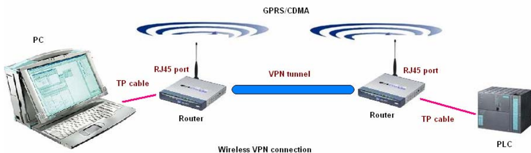
图 15：通过无线宽带路由器建立 VPN
