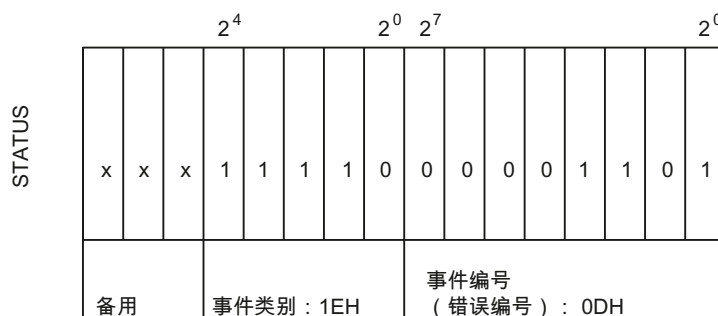
图 8-2 实例：用于“请求因完全重新启动、重新启动或复位而取消”事件的 STATUS 参数的结构
