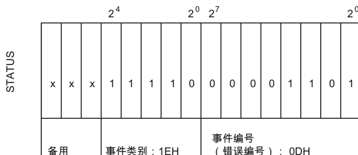
图 8-2 实例：“作业因暖启动、热启动或复位而终止”事件的 STATUS 参数的结构
