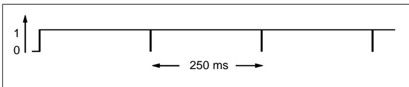
每隔250毫秒RLO位为0。忽略跳转且存储器字MW100的内容增加1。
