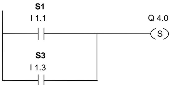
程序段2：按下任一停止开关或打开传送带尾部的常闭触点以关闭电机。
