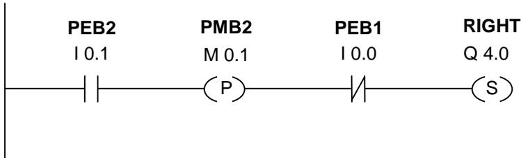
程序段3：如果两个光电屏障都未中断，则表明屏障之间没有包裹。方向指针关闭。
