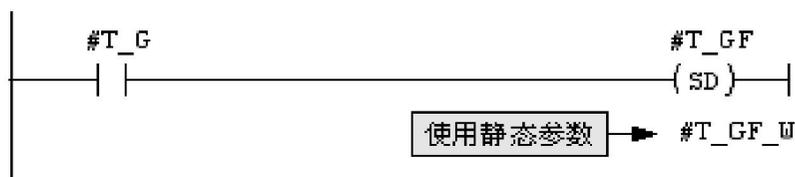
**Network 4:** 另一方向的黄色信号灯延时控制
