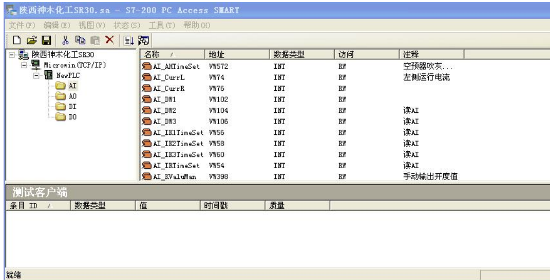
图 12 利用 S7-200 PC Access SMART 软件通过以太网来与工控机进行 OPC 通讯画面
