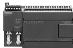
本机集成 14 输入/10 输出共 24 个数字量 I/O 点, 2 输入/1 输出共 3 个模拟量 I/O 点, 可连接 7 个扩展模块, 最大扩展至 168 路数字量 I/O 点或 38 路模拟量 I/O 点。22K 字节程序和数据存储空间, 6 个独立的高速计数器(100KHz), 2 个 100KHz 的高速脉冲输出, 2 个 RS485 通讯/编程口, 具有 PPI 通讯协议、MPI 通讯协议和自由方式通讯能力。本机还新增多种功能, 如内置模拟量 I/O, 位控特性, 自整定 PID 功能, 线性斜坡脉冲指令, 诊断 LED, 数据记录及配方功能等。是具有模拟量 I/O 和强大控制能力的新型 CPU。
