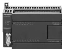
本机集成 14 输入/10 输出共 24 个数字量 I/O 点。可连接 7 个扩展模块, 最大扩展至 168 路数字量 I/O 点或 35 路模拟量 I/O 点。16K 字节程序和数据存储空间。6 个独立的 30kHz 高速计数器, 2 路独立的 20kHz 高速脉冲输出, 具有 PID 控制器。1 个 RS485 通讯/编程口, 具有 PPI 通讯协议、MPI 通讯协议和自由方式通讯能力。I/O 端子排可很容易地整体拆卸。是具有较强控制能力的控制器。
