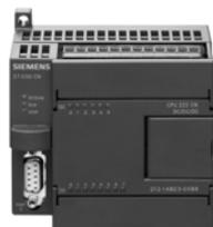
本机集成 8 输入/6 输出共 14 个数字量 I/O 点。可连接 2 个扩展模块, 最大扩展至 78 路数字量 I/O 点或 10 路模拟量 I/O 点。6K 字节程序和数据存储空间。4 个独立的 30kHz 高速计数器, 2 路独立的 20kHz 高速脉冲输出, 具有 PID 控制器。1 个 RS485 通讯/编程口, 具有 PPI 通讯协议、MPI 通讯协议和自由方式通讯能力。是具有扩展能力的、适应性更广泛的全功能控制器。
