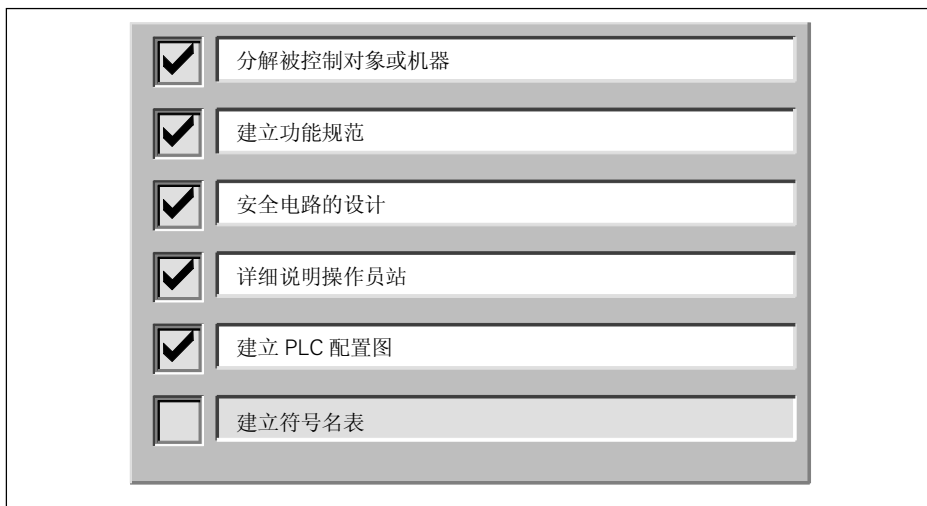
图 4-1 规划一个 PLC 系统的基本步骤
