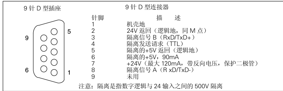
图A-27 DP从站端口连接器的插针
