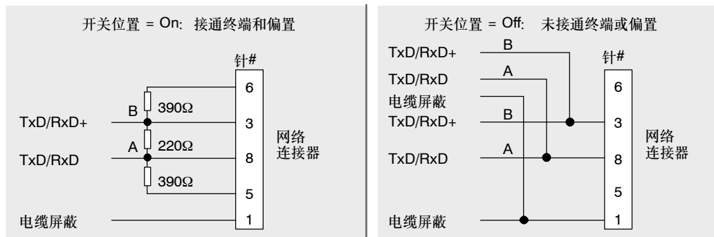
图11-5 网络电缆的偏置和终端
