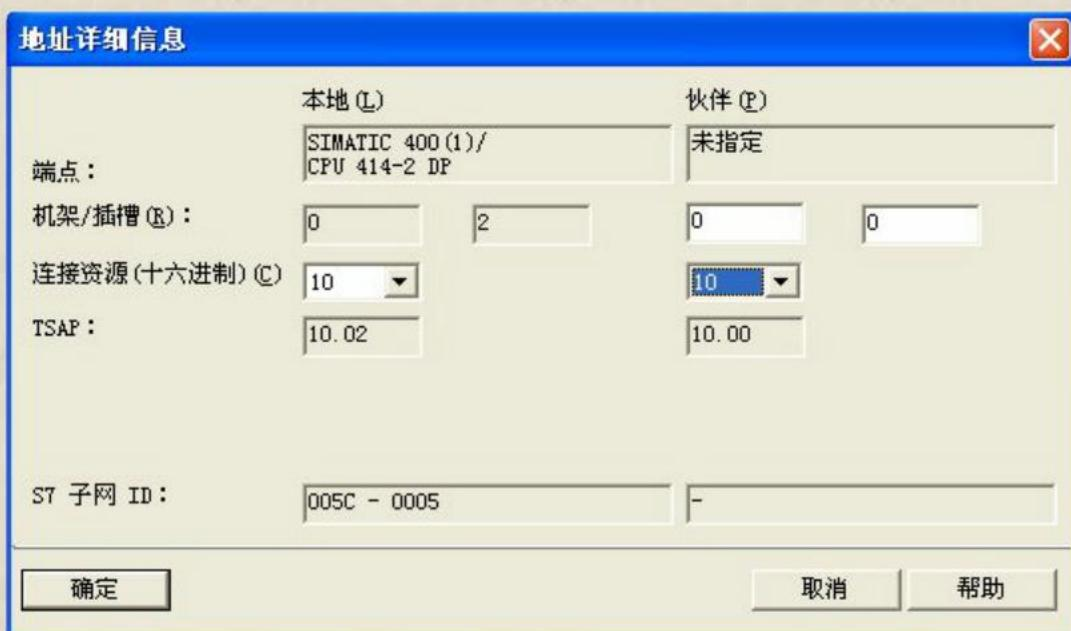
(7) 至此，双方的以太网通信已经组态完毕，接下来需要在 Client (S7-400) 端调用程序块向 Server (S7-200) 读取和发送数据。
