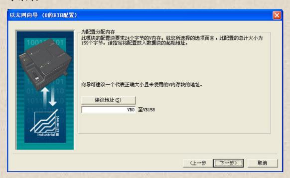
(9) 至此, S7-200 服务器端的以太网通信已经组态完毕, 如下图, 给出了组态后的信息。点击"完成"保存组态信息。
