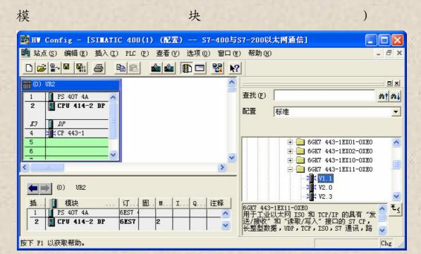
(2) 在放入 CP433-1 模块时,会自动弹出"属性-Ethernet 接口"对话框,设置 IP 地址和子网掩杩码。
