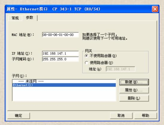
至此,一个以 S7-200 作为 Client 端, S7-300 作为 Server 端的以太 网通信系统已经组态完毕,这时在 S7-200 端触发子程序 ETHO\_XFR 就 可以进行 S7-200 和 S7-300 间的数据交换了。
