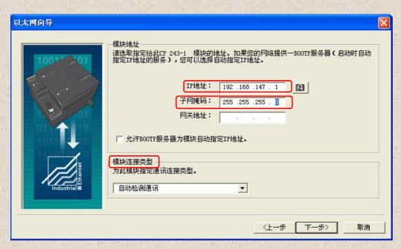
(5) 确定 PLC 为 CP243-1 分布的输出口的起始字节地址(一般使用 缺省值即可)和连接数据数,点击"下一步"。
