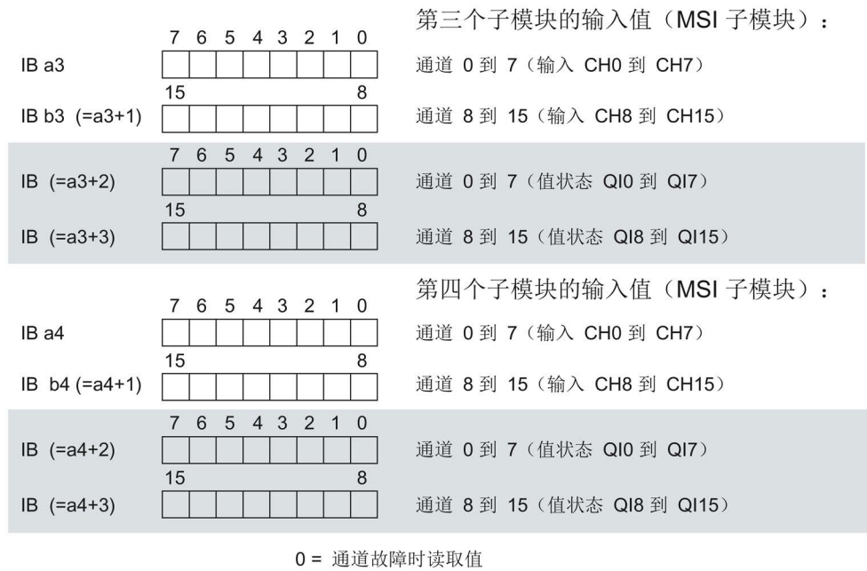
图 4-4 组态为 1 x 16 通道 DI 16x24VDC HF MSI 的地址空间
