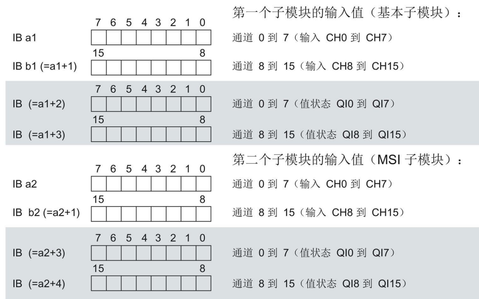
图 4-3 组态为 1 x 16 通道 DI 16x24VDC HF MSI 的地址空间
