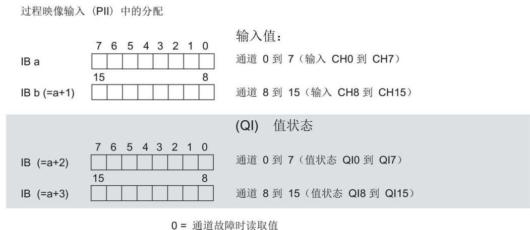
图 4-1 组态为带值状态的 16 通道 DI 16x24VDC HF QI 的地址空间
