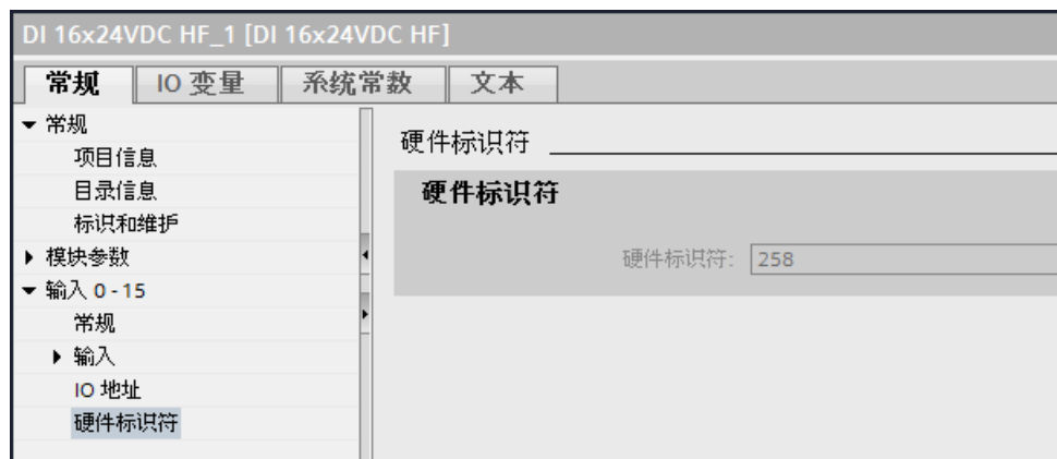
图 6-6 STEP 7 中的硬件标识符示例
