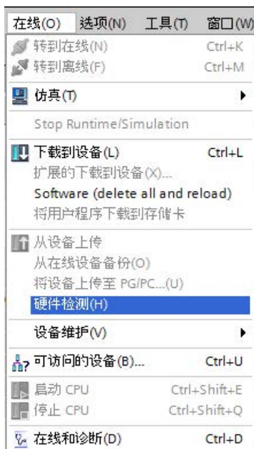
图 6-2 在线菜单中的硬件检测
