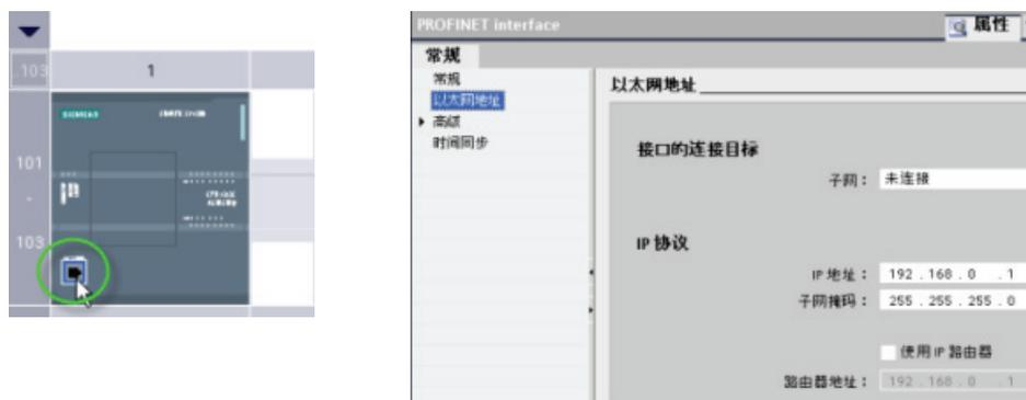
1. 选择 CPU 上的 PROFINET 端口，那么仅显示 PROFINET 接口的属性。（也可以在 CPU 的“常规”(General) 属性中选择“PROFINET 接口”(PROFINET interface)。）
