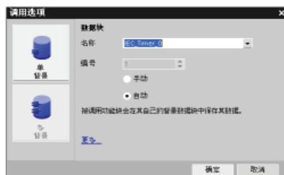
将 TON 指令拖放到程序段后，将自动创建一个用于存储定时器数据的单个背景数据块 (DB, Data Block)。
