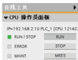
使用 CPU 操作面板可更改"操作模式。单击“RUN”或“STOP”按钮可更改 CPU 的"操作模式。
