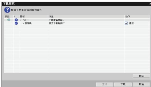
在“加载预览”(Load preview) 对话框中，单击“加载”(Load) 将用户程序下载到 CPU 中。
