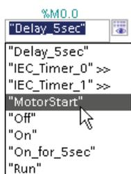
启动 TOF 定时器不再需要“Delay\_5sec”输出（M 存储器中的某一位）。只需重命名“Delay\_5sec”输出即可，而无需删除该输出。
