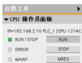
使用操作员面板上的按钮更改操作模式（STOP 或 RUN）。操作员面板还提供了用于复位存储器的 MRES 按钮。
