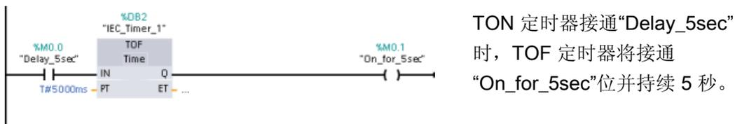
TON 定时器接通“Delay\_5sec”时，TOF 定时器将接通“On\_for\_5sec”位并持续 5 秒。
