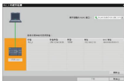
STEP 7 Basic 将“检测”与该计算机连接的所有 CPU。选择 CPU，然后单击“加载”(Load) 按钮将 CPU 组态加载到项目。
