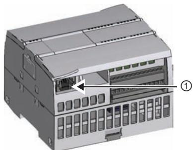
① 将 PROFINET 电缆的一端插入 CPU。
