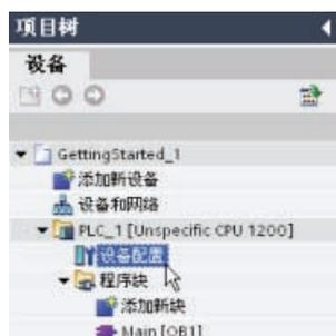
可以使用“设备组态”(Device Configuration) 的“检测 CPU”(Detect CPU) 功能上传 CPU 的硬件配置。
