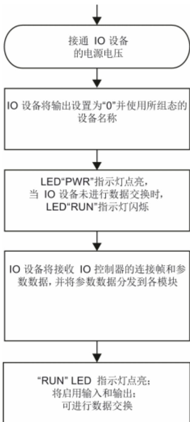
图 7-1 启动 PROFINET IO 上的 ET 200SP
