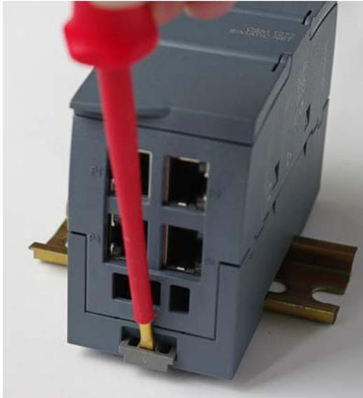
图 4-3 从导轨上拆下 CSM 1277
