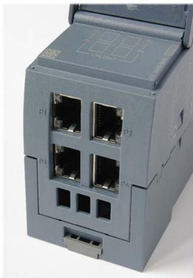
图 3-2 RJ-45 插孔
