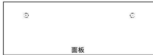
2) 将基板右端的缺口卡在右端的螺钉上。
