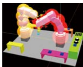
用立体模型定义机械手臂，进行碰撞检查
