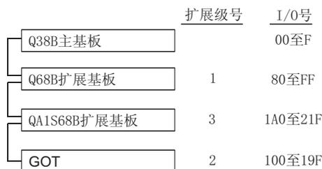
图 2.22 在所有插槽上安装 16 点模块时的 I/O 号
