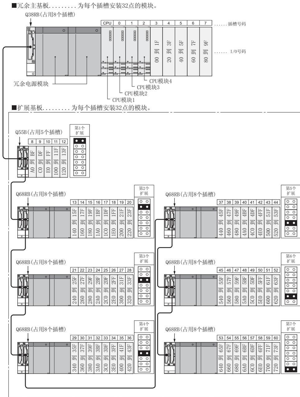
图 2.7 当使用 Q3□RB 时的系统组态实例
