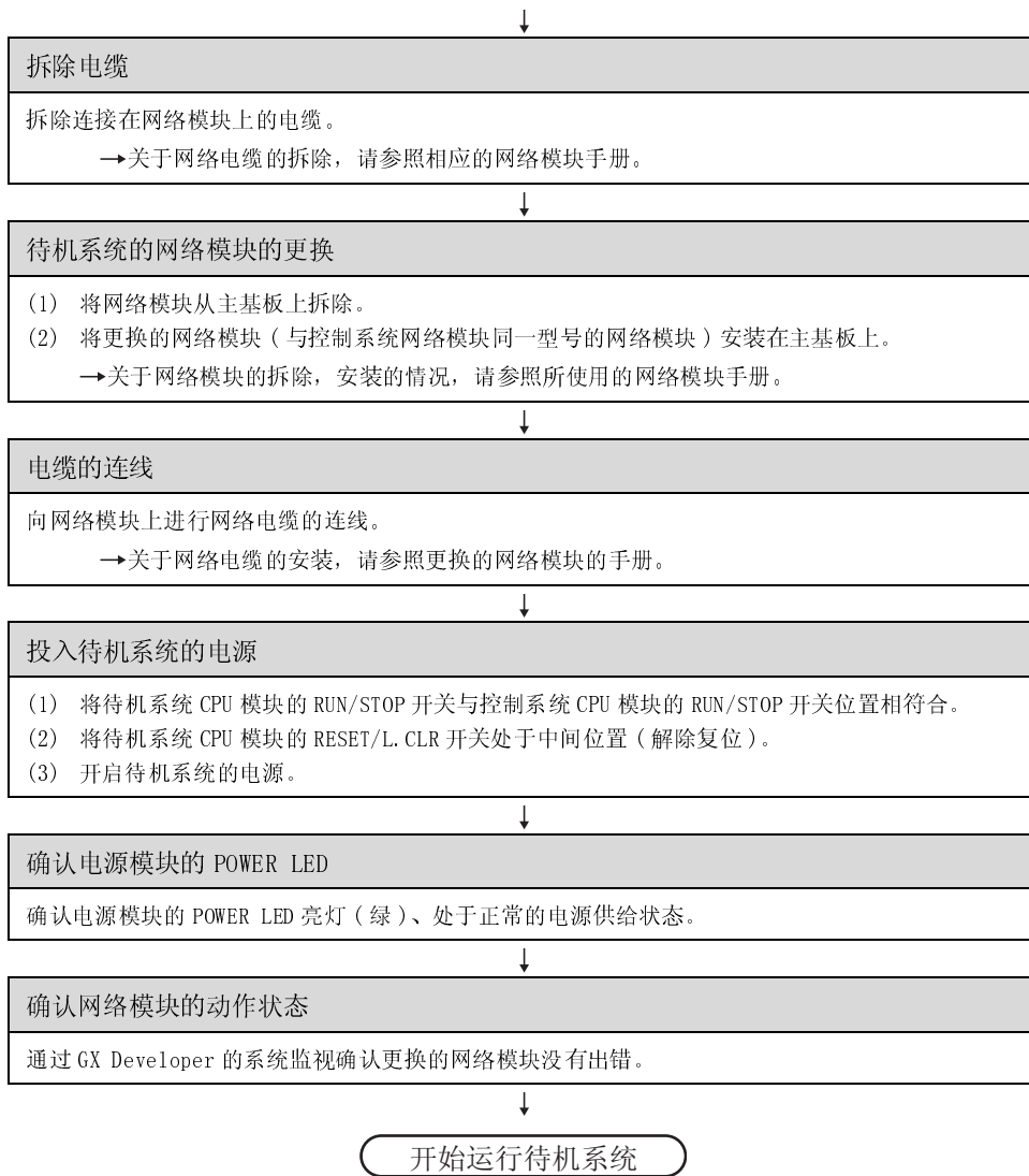
图 8.24 网络模块的更换步骤
