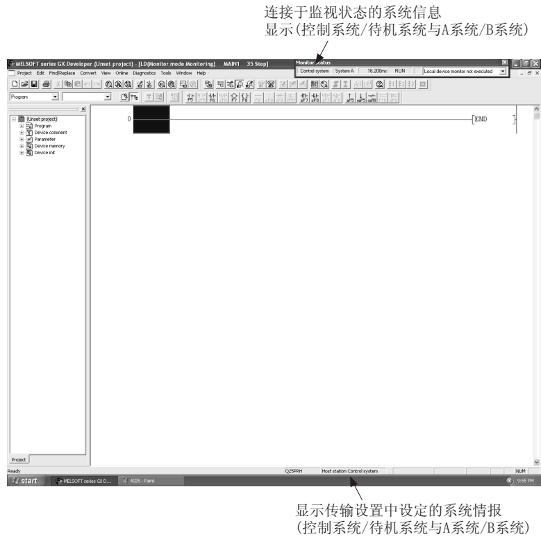
图 6.2 GX Developer 的梯形图监视画面
