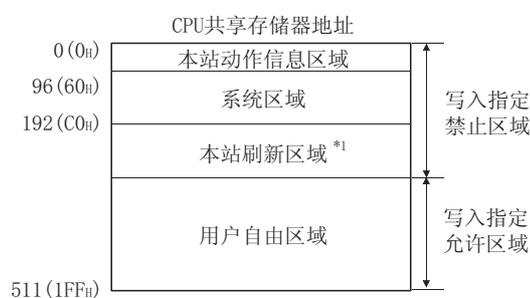
(b) 高性能型 QCPU、通用型 QCPU\*2 时的 CPU 共享存储器地址
