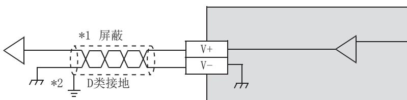
\*1 模拟输出线应使用双芯的屏蔽双绞电缆，且配线时应与其他动力线及容易受电感影响的线隔离。
