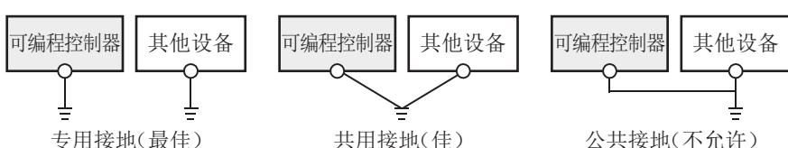
• 应使用粗细为AWG14 (2mm<sup>2</sup>) 以上的接地线。
