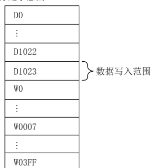
软元件/标签存储器的分配示意图
