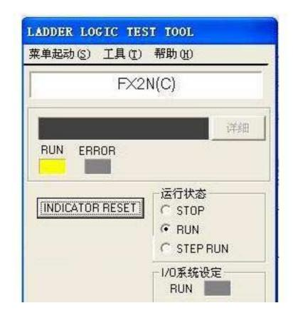
(6) 启动仿真后,程序开始在电脑上模拟 PLC 写入过程。
