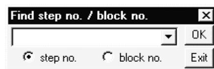
单击 **OK** 按钮或按 **Enter** 键允许光标移至当前显示的 SFC 图表的指定步。同时，选中块号收音机按钮进行块查找。
