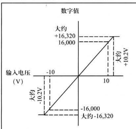
1. 电压输入，-10 到 +10V， $20V \times 1/8,000$
