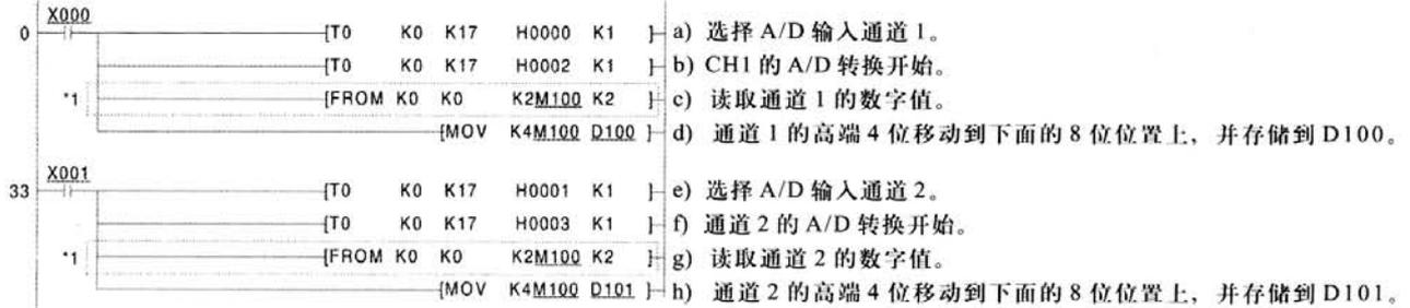
通道 1 的输入执行模拟到数字的转换: X000。
