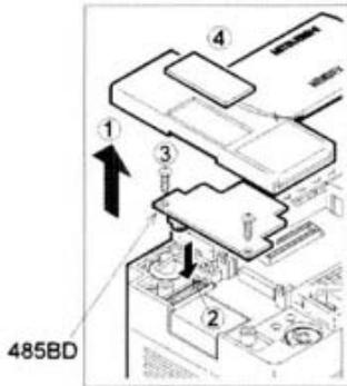
关闭可编程控制器的电源，并使用下述步骤安装 485BD。
