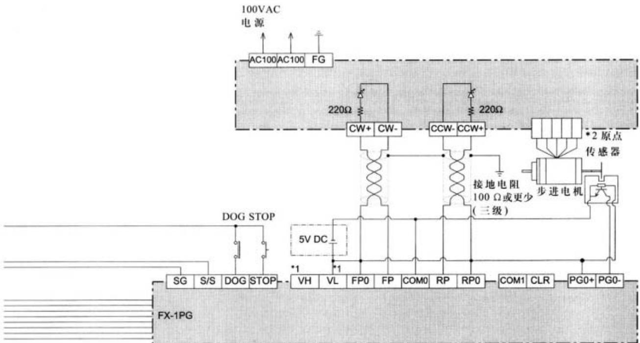
9.2 FX<sub>2N</sub>-1PG 和步进电机连接的例子
