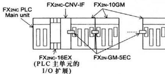
使用FX<sub>2N</sub>-GM-5EC 电缆，将FX<sub>2N</sub>-10GM 连接到FX<sub>2N</sub> PLC。当需要较长距离时，每个系统可使用一个FX<sub>2N</sub>-GM-65EC 电缆。为了连接到FX<sub>2N</sub> PLC，需要使用FX<sub>2N</sub>-CNV-IF。可有8个模块连接到一个FX<sub>2N</sub> PLC，4个模块连接到一个FX<sub>2N</sub> PLC。
