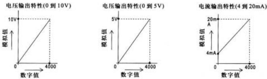
电压输出时，对于10V的模拟输出值，数字值调整到4000。
