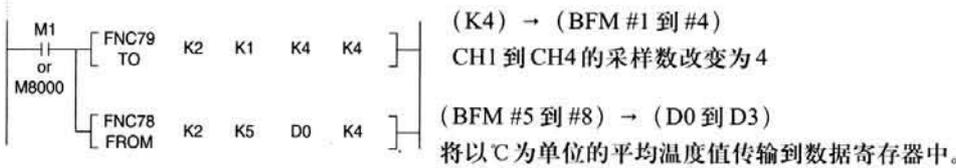
这一步是对 FX<sub>2N</sub>-4AD-PT 输入通道的实际读数。这是程序中唯一必须的步骤。例中的 “TO” 指令设置输入通道, CH1 到 CH4, 并对四个采样值进行平均读取。“FROM” 指令读取 FX<sub>2N</sub>-4AD-PT 输入通道 CH1 到 CH4 的平均温度 (BFM #5 到 #8)。如果需要读取直接温度读数, 则以读取 BFM #9 到 #12 来代替。
