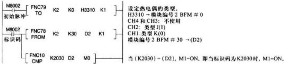
此初始化步骤检查在位置 2 的特殊功能模块的确是 FX<sub>2N</sub>-4AD-TC，即它的单元标识码是否是 K2030 (BFM #30)。这一步是可选的，不过它提供了确定系统是否正确配置的软件检查。
