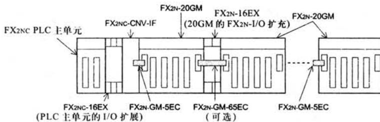
使用 FX<sub>2N</sub>-GM-5EC 电缆，将 FX<sub>2N</sub>-20GM 连接到 FX<sub>2N</sub> PLC 上。当需要较长距离时，每个系统可使用一个 FX<sub>2N</sub>-GM-65EC 电缆。为了连接到 FX<sub>2N</sub>C PLC，需要使用 FX<sub>2N</sub>C-CN-V-F。可将 8 个模块连接到一个 FX<sub>2N</sub> PLC，4 个模块连接到一个 FX<sub>2N</sub>C PLC 上。
