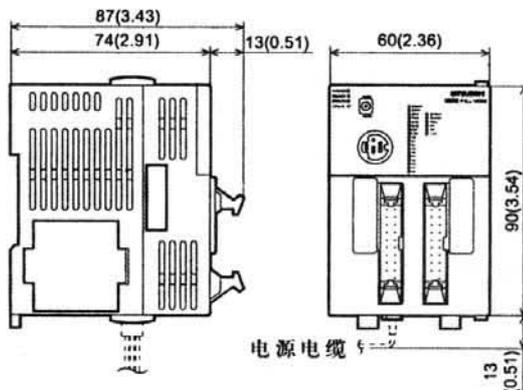
Din 导轨宽度: 35 毫米
