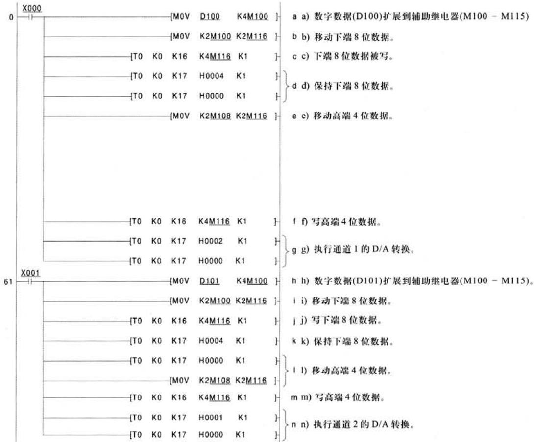
通道 1 的输入执行数字到模拟的转换: X000
