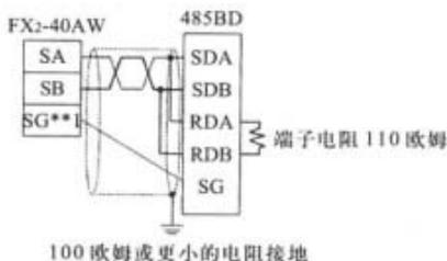
\*\*1 将 SG 端子连接到 FX 或 FX<sub>2c</sub> 主单元的端子 SG。
