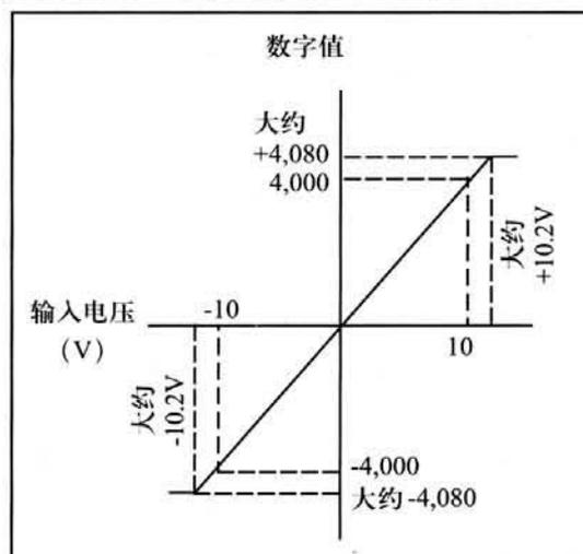
2. 电压输入，直接显示 (-10,000 到 +10,000)
