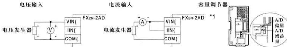
\*1 如果安装在FX2N-2AD上的容量调节器转向右边时(顺时针)，数字值增加。
