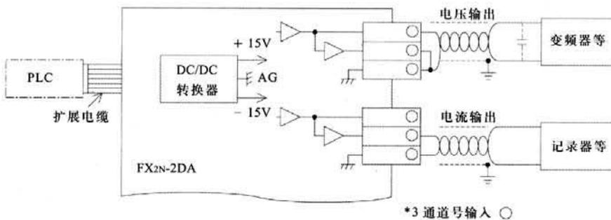
\*1 当电压输出存在波动或有大量噪声时, 在位置 \*1 处连接 0.1 到 0.47  $\mu$  F 25V DC 的电容。
