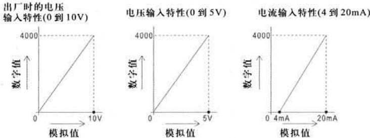
在电压输入时，对于10V的模拟输入值，数字值调整到4000。
