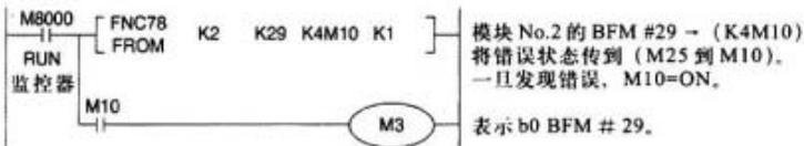
这一步提供了对 FX<sub>2N</sub>-4AD-TC 的错误缓冲存储器 (#29) 的可选监控。如果在 FX<sub>2N</sub>-4AD-TC 中存在错误，BFM #29 的 b0 位将设为 ON。它可以被此程序步读出，并且作为一个 FX<sub>2N</sub> 可编程控制器中的位设备输出（此例中是 M3）。额外的错误设备可以采用同样的方式输出，比如 BFM #29 数字范围错误的 b10。（见下面）
