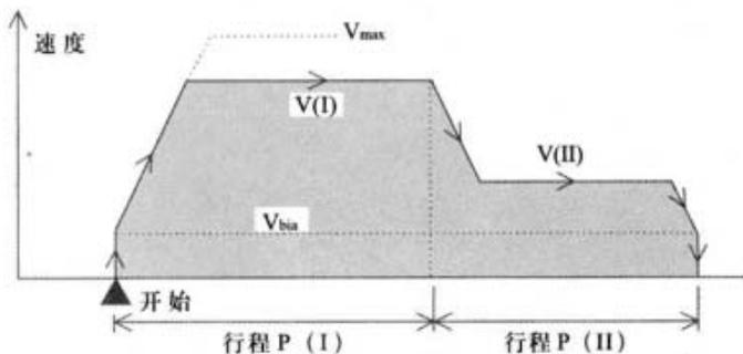
当接收到起始命令时，马达以操作速度  $V(I)$  (BFM#20 和 #19) 执行定位直至设置的位置  $P(I)$  (BFM#18 和 #17)，然后以操作速度  $V(II)$  (BFM#24 和 #23) 操作直至设置的位置  $P(II)$  (BFM#22 和 #21) (双步速度)。
