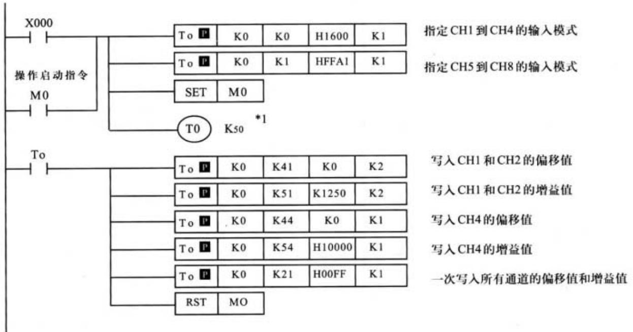
\*1 改变输入模式 (BFM #0, BFM#1) (改变每一个设定值) 大约需要 5 秒钟的时间。确保修改完输入模式后到执行写入每一个设置 (TO 指令) 之间至少有 5 秒的间隔。
