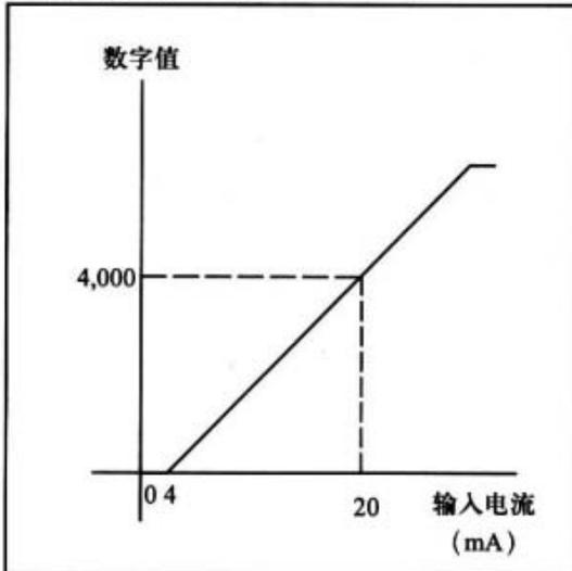
5. 电流输入，直接显示 (4,000 到 20,000)
