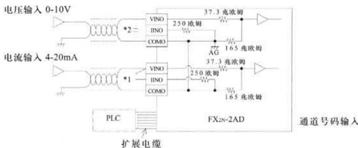
\*1 FX<sub>2N</sub>-2AD 不能将一个通道作为模拟电压输入而将另一个作为电流输入,这是因为两个通道使用相同的偏值量和增益值。
