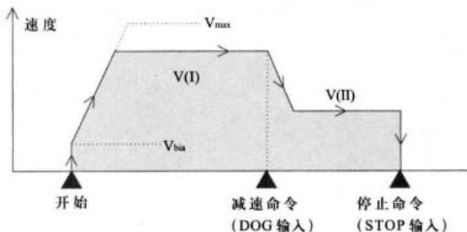
当接收到起始命令时，马达以操作速度  $V(I)$  (BFM#20 和 #19) 执行定位直至收到减速命令。此时马达减速到操作速度  $V(II)$  (BFM#24 和 #23)。当接收到停止命令时，脉冲的产生会立即停止。
