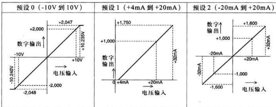
注: 预设范围根据模拟模块缓冲存储器的适当设置进行选择。所选电流/电压输入必须和正确的输入端子连接相匹配。
