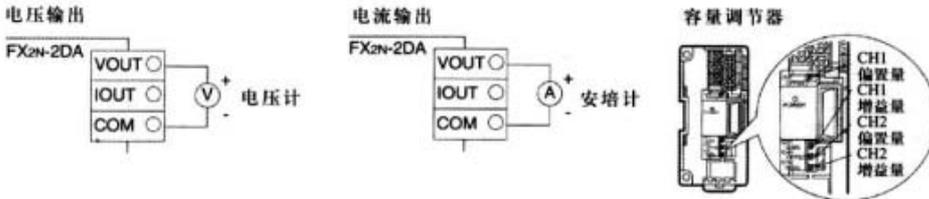
\*1 如果安装在FX<sub>2N</sub>-2DA上的容量调节器转向右边时(顺时针)，数字值增加。
