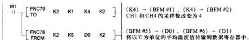
这一步是对 FX<sub>2N</sub>-4AD-TC 输入通道实际读数。这是程序中仅有的必须步骤。例中的“TO”指令设置输入通道，CH1 和 CH2，并对四个采样值读数进行平均。
