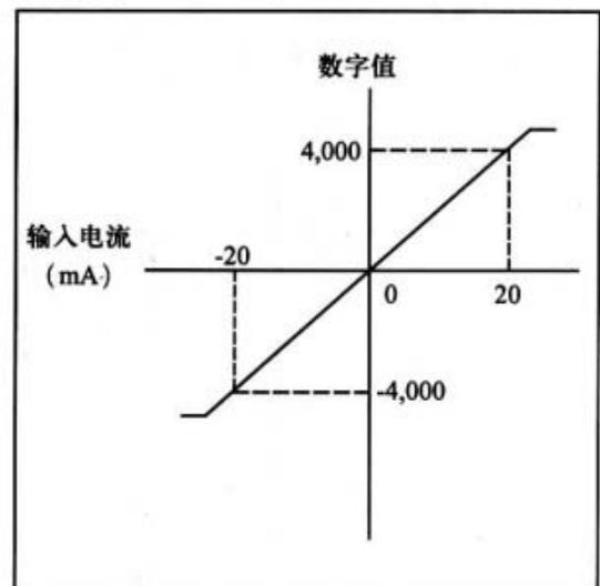
8. 电流输入，直接显示 (-20,000 到 +20,000)
