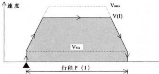
当给出开始命令时，马达加速到操作  $V(I)$  (BFM#20 和 #19)，然后减速并停在设置位置  $P(I)$  (BFM#18 和 #17)。离当前位置 CP 变为 0 (电气原位) 的点的绝对位置或由起始位置开始的相对位置可以被指定为设置位置。当使用伺服电机时， $V_{bia}$  通常设置为 0。
