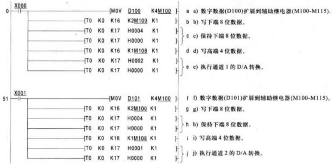
通道 1 的输入执行数字到模拟的转换: X000
