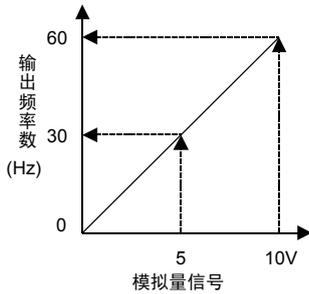
希望按照如下所示进行频率控制时，则可以采用这样的方法进行控制：对与频率成比例的模拟量信号使用表格输出功能。
