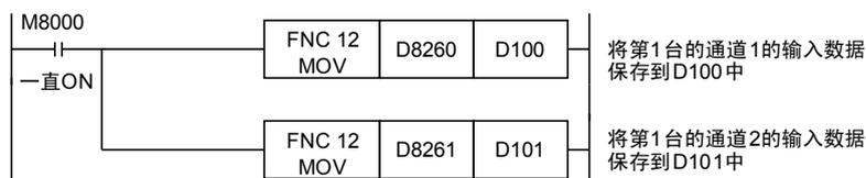
即使不在D100、D101中保存输入数据，也可以在定时器、计数器的设定值或者PID指令等中直接使用D8260、D8261。
