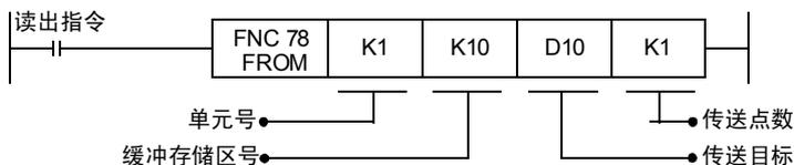
在上述程序中，将单元号1的缓冲存储区(BFM #10)的内容(1点)读出到数据寄存器(D10)中。
