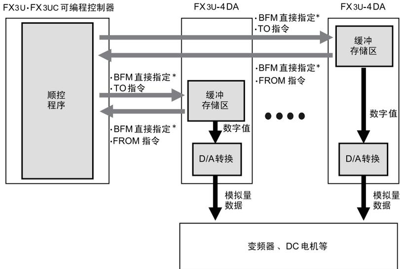
\* 通过缓冲存储区的直接指定(U□V□)方式，可以在应用指令的源操作数或者目标操作数中直接指定缓冲存储区，从而使程序高效化。(仅对应FX3U、FX3UC可编程控制器。)
