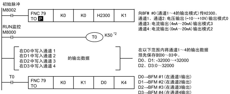
\*2 请设计输出模式设定后，各设定的写入时间在5秒以上。但是，一旦指定了输出模式，是被停电保持的。此后如果使用相同的输出模式，则可以省略输出模式的指定以及T0 K50的等待时间。
