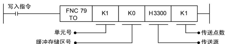
在上述程序中，向单元号1的缓冲存储区(BFM #0)写入1个数据(H3300)。
