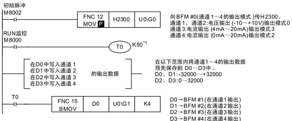
\*1 请设计输出模式设定后，各设定的写入时间在5秒以上。但是，一旦指定了输出模式，是被停电保持的。此后如果使用相同的输出模式，则可以省略输出模式的指定以及T0 K50的等待时间。
