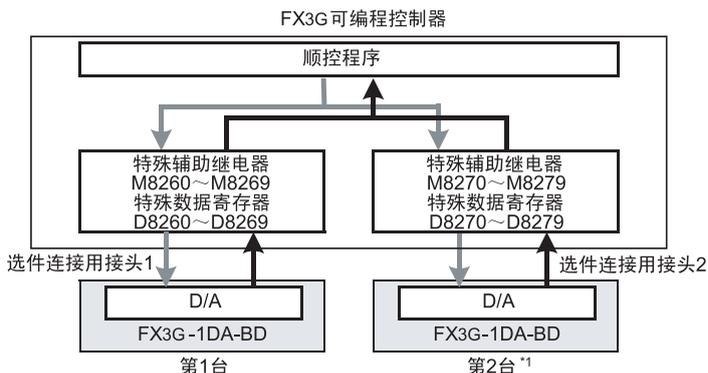
与选件连接用接头1连接的功能扩展板记作第1块，与选件连接用接头2连接的功能扩展板记作第2块。
