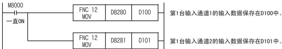
即使不在D100、D101中保存输入数据，也可以在定时器、计数器的设定值或者PID指令等中直接使用D8280、D8281。
