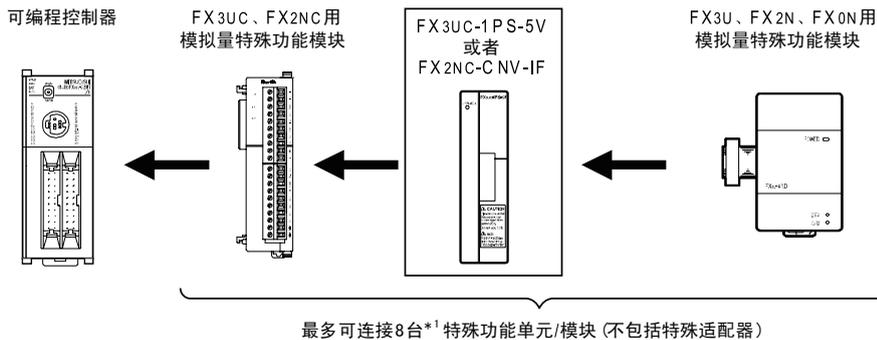
\*1. 连接在FX3UC-32MT-LT(-2)上时，最多可以连接7台。
