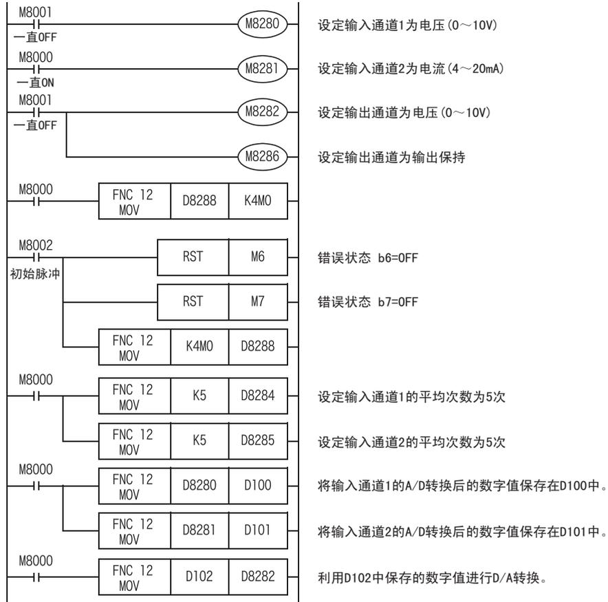
即使不在D100、D101中保存输入数据，也可以在定时器、计数器的设定值或者PID指令等中直接使用D8260、D8261。
