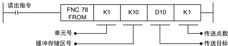
在上述程序中, 将单元号1的缓冲存储区(BFM #10)的内容(1点)读出到数据寄存器(D10)中。
