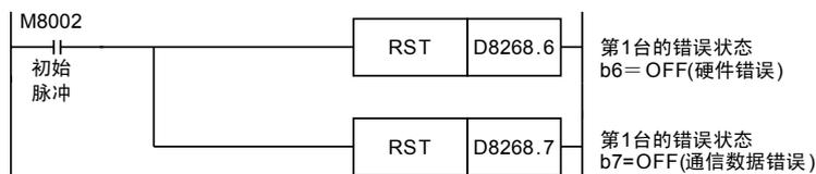
2. 程序举例1(用于FX3G、FX3U、FX3UC可编程控制器)
