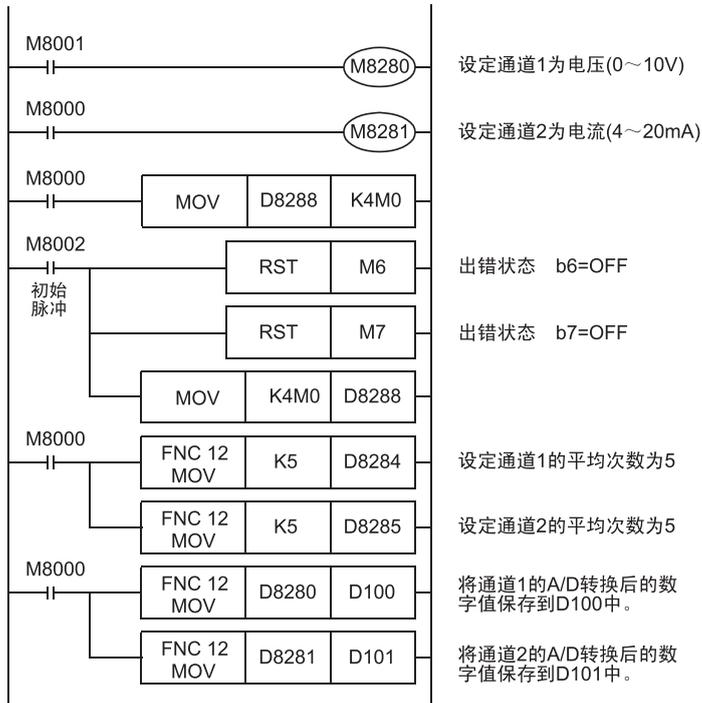
即使不在D100、D101中保存输入数据，也可以在定时器、计数器的设定值或者PID指令等中直接使用D8280、D8281。
