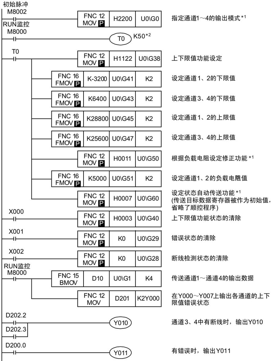
\*1. 输出模式的设定、根据负载特性设定的修正功能、状态自动传送功能的设定, 是由 FX3U-4DA 中的 EEPROM 保持的, 因此一旦设定后, 即使删除顺控程序也能动作。
