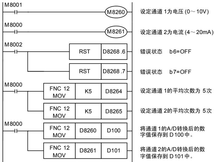
即使不在D100、D101中保存输入数据，也可以在定时器、计数器的设定值或者PID指令等中直接使用D8260、D8261。
