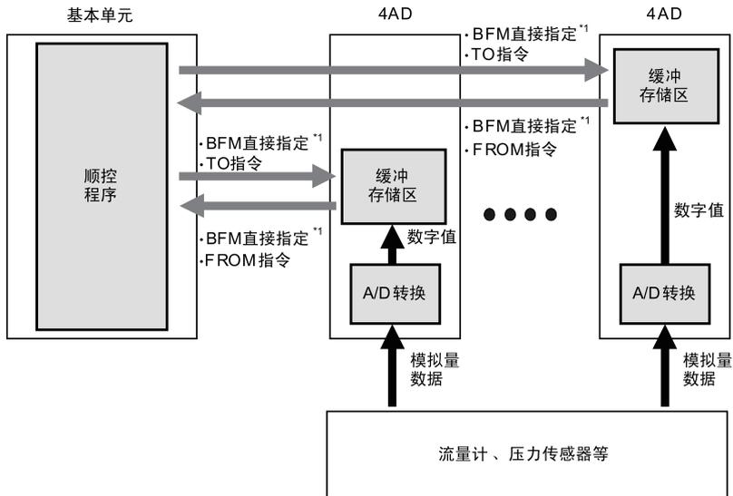
\*1. 缓冲存储区的直接指定 (U□\G□)，可以在应用指令的源操作数或者目标操作数中直接指定缓冲存储区，从而使程序高效化。(仅对应FX3u、FX3uc可编程控制器。)
