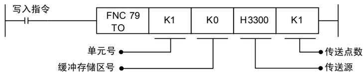
在上述程序中, 向单元号1的缓冲存储区(BFM #0)写入数据(H3300、1点)。
