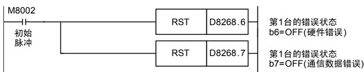
2. 程序举例1(用于FX3G、FX3U、FX3UC可编程控制器)
