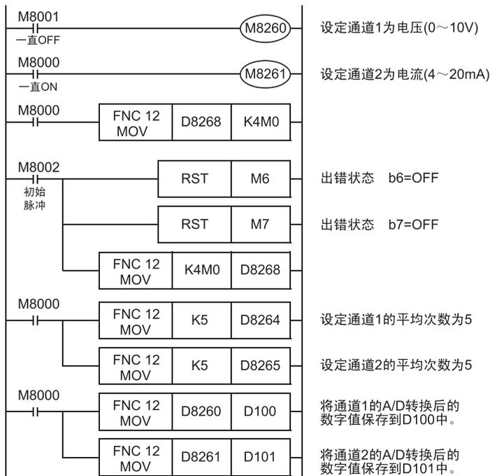
即使不在D100、D101中保存输入数据, 也可以在定时器、计数器的设定值或者PID指令等中直接使用D8260、D8261。
