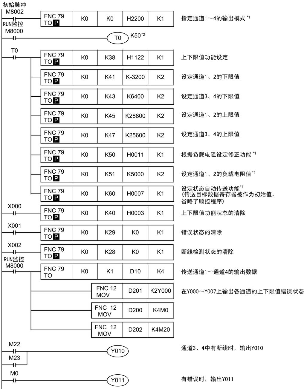
\*1. 输出模式的设定、根据负载特性设定的修正功能、状态自动传送功能的设定，是由FX3U-4DA中的EEPROM保持的，因此一旦设定后，即使删除顺控程序也能动作。
