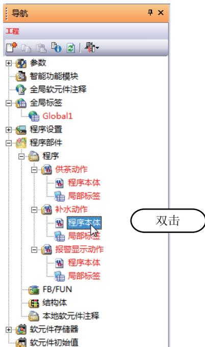
1. 如果对工程视窗的“程序部件” → “程序” → “补水动作” → “程序本体”进行双击，将显示补水动作 [PRG] 程序本体 [结构化梯形图 / FBD]。
