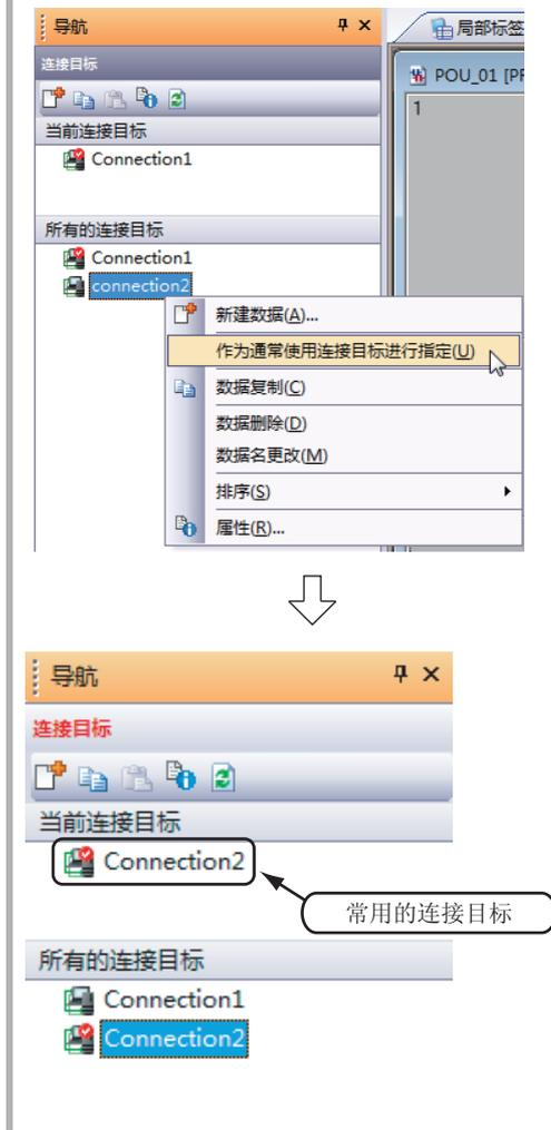
1. 选择连接目标视窗的所有连接目标“Connection2”后，点击鼠标右键，选择“作为通常使用连接目标进行指定”菜单。
