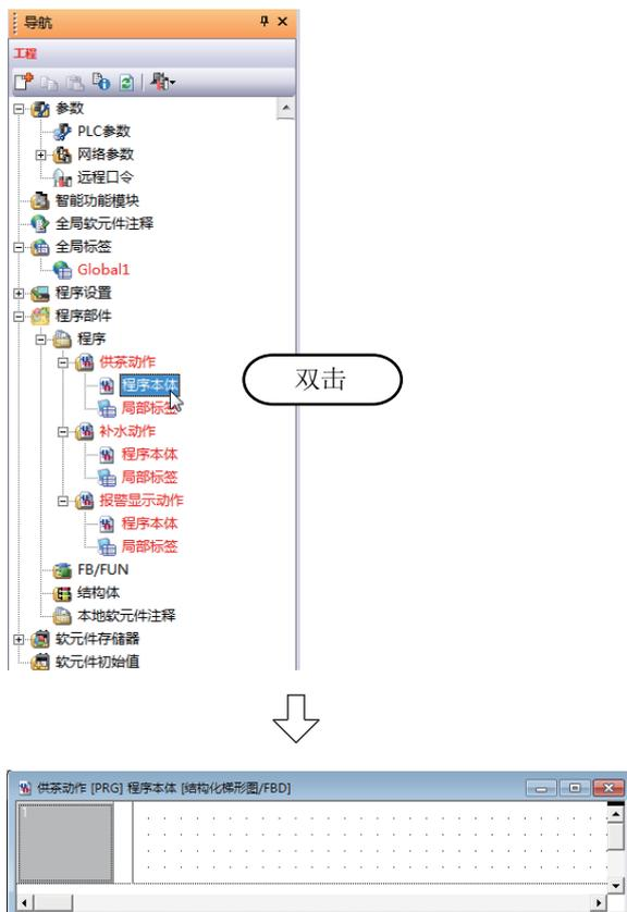
1. 如果对工程视窗的“程序部件” → “程序” → “供茶动作” → “程序本体”进行双击，将显示供茶动作 [PRG] 程序本体 [结构化梯形图 / FBD]。
