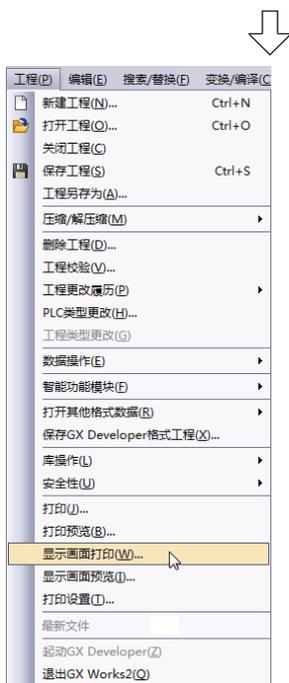
2. 选择 [工程] → [显示画面打印] 时，将显示显示画面打印画面。
