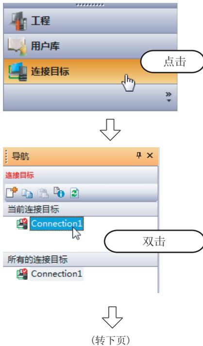
1. 在导航窗口的视窗选择区域中点击“连接目标”时，将显示连接目标视窗。
