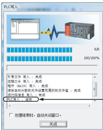
4. 写入过程中将显示如左所示的画面。写入结束时将显示“PLC 写入：结束”。
