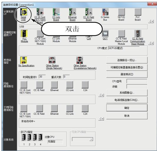
3. 如果对“计算机侧 I/F”的“
