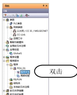
2. 如果对工程视窗的“程序部件” → “程序” → “POU\_01” → “程序本体”进行双击，将显示 POU\_01[PRG] 程序本体 [结构化梯形图 / FBD] 画面。
