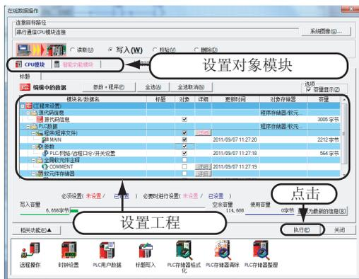
2. 在在线数据操作画面中对对象模块、工程进行设置。
