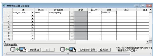
5. 对全局标签设置画面的“软元件”进行直接输入。
