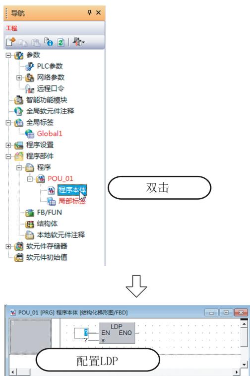
1. 如果对工程视窗的“程序部件” → “程序” → “POU\_01” → “程序本体”进行双击，将显示 POU\_01 [PRG] 程序本体 [结构化梯形图 / FBD] 画面。
