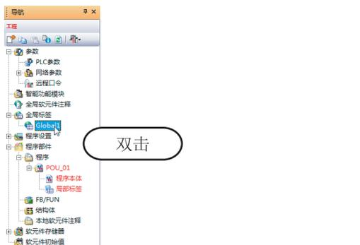
1. 对工程视图的“全局标签” → “Global1”进行双击时，将显示全局标签设置画面。
