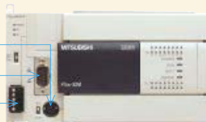
照片是FX3U-232-BD+FX3U-485ADP的连接示例
