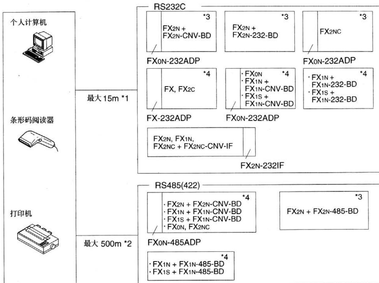
\*1 当使用计算机的RS485接口连接时，需要RS485/RS232C信号转换器。
