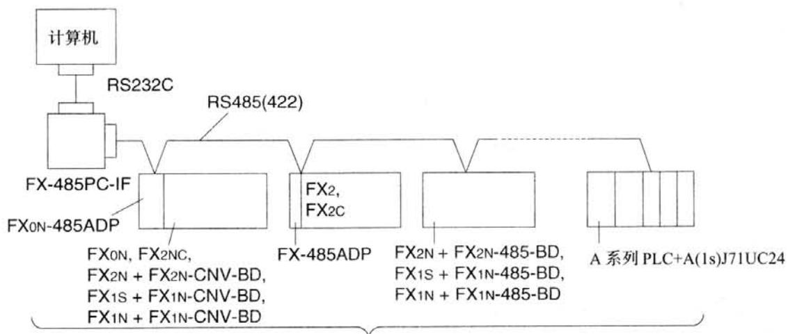
当在此系统中不包括 FX<sub>2N</sub>-485-BD 或 FX<sub>1N</sub>-485-BD 时, 延伸距离最大 500m (使用 : 最大 50m)。
