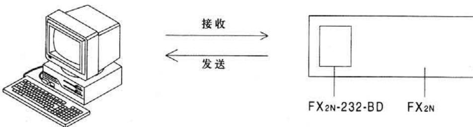
使用适于个人电脑接口针脚分配的通讯电缆。(代表性连线请参见第二章)
