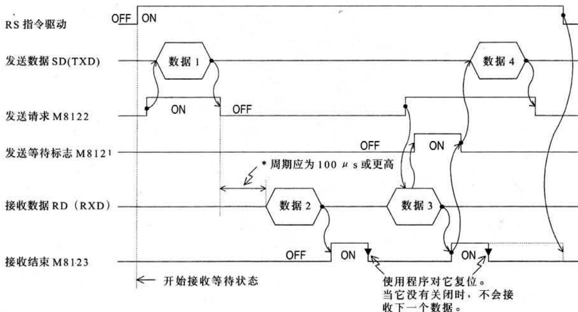
\* 在 FX<sub>1S</sub>, FX<sub>1N</sub>, FX<sub>0N</sub>, FX 和 FX<sub>2C</sub> 系列中, 周期应为 2 个扫描周期或更长。
