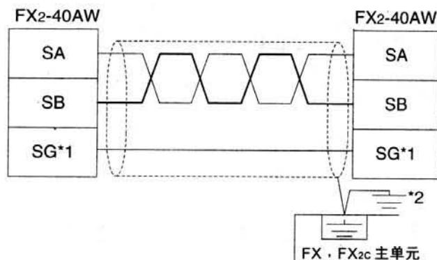
\*1 FX<sub>2</sub>-40AW 的 SG 端子连接 FX 或 FX<sub>2c</sub> 主单元的 SG 端子。
