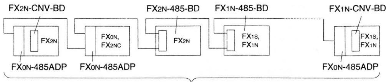
当在此系统中不使用 FX<sub>2N</sub>-485-BD 或 FX<sub>1N</sub>-485-BD 时，最大延伸距离 500m（使用时：最大 50m）
