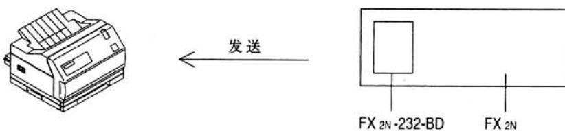
使用与打印机的端口针脚相匹配的连接电缆。(相关接线请参见第二章)
