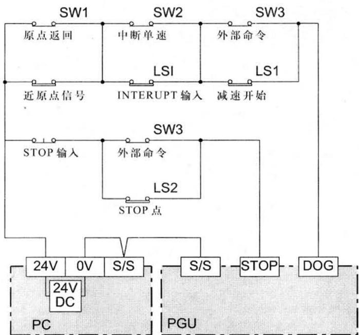
根据操作的类型，选择输入开关SW1到SW3。
