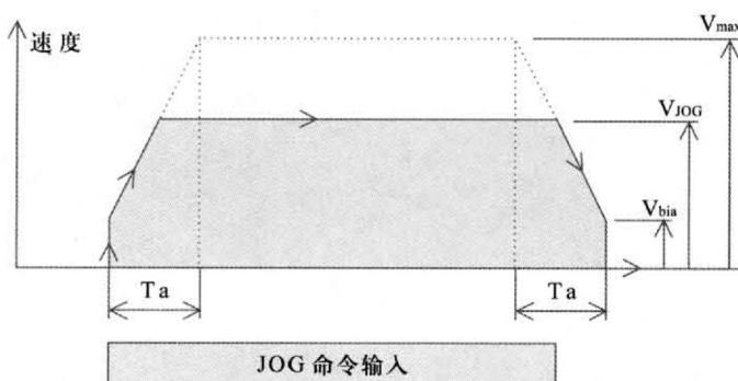
任何在偏置速度  $V_{bia}$  (BFM#6) 和最大速度  $V_{max}$  (BFM#5 和 #4) 之间的值就可以作为命令速度  $V_{JOG}$  (BFM#8 和 #7)。加速 / 减速时间  $T_a$  (BFM#15) 是  $V_{bia}$  和  $V_{max}$  之间的时间。
