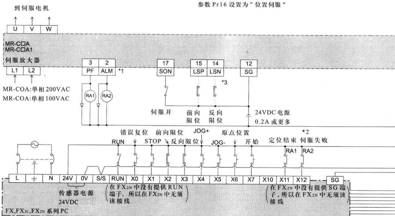
\*1 要释放警报状态, 先关闭电源, 消除警报的原因, 然后再接上电源。
