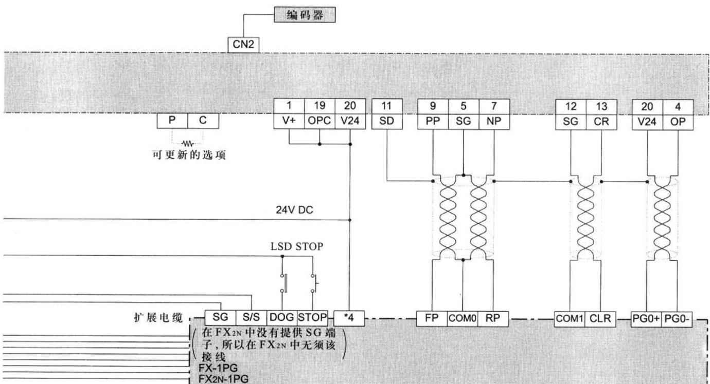
\*4 FX-1PG: 当外部电源是 24VDC 时, 连接 VH 端子。当外部电源是 5VDC 时, 连接 VL 端子。
