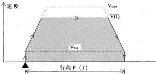
当给出开始命令时，马达加速到操作  $V(I)$  (BFM#20 和 #19)，然后减速并停在设置位置  $P(I)$  (BFM#18 和 #17)。离当前位置 CP 变为 0 (电气原位) 的点的绝对位置或由启始位置开始的相对位置可以被指定为设置位置。当使用伺服电机时， $V_{bias}$  通常设置为 0。
