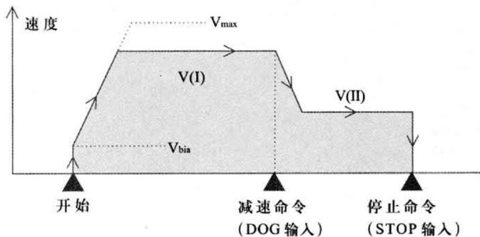
当接收到启始命令时，马达以操作速度 V (I) (BFM#20 和 #19) 执行定位直至收到减速命令。此时马达减速到操作速度 V (II) (BFM#24 和 #23)。当接收到停止命令时，脉冲的产生会立即停止。
