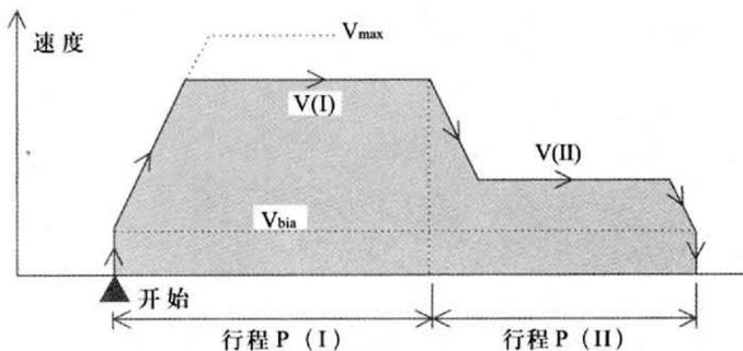
当接收到启始命令时，马达以操作速度 V (I) (BFM#20 和 #19) 执行定位直至设置的位置 P (I) (BFM#18 和 #17)，然后以操作速度 V (II) (BFM#24 和 #23) 操作直至设置的位置 P (I) (BFM#22 和 #21) (双步速度)。
