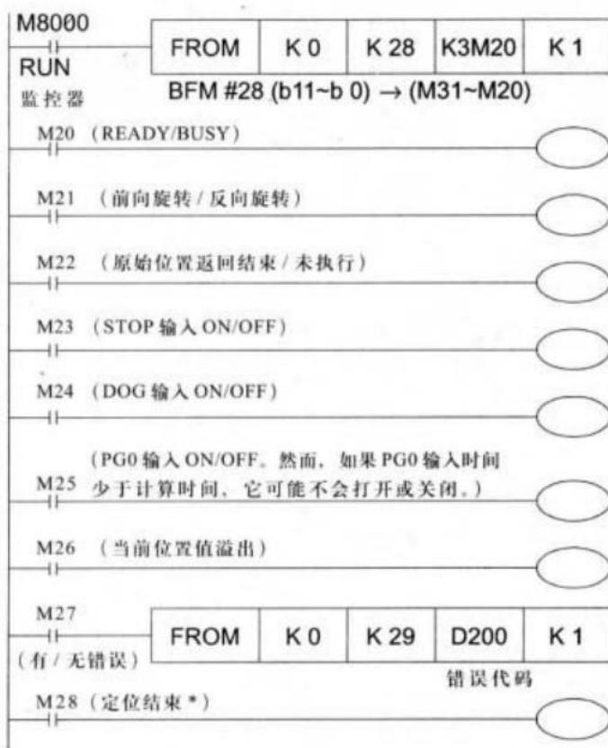
\* 当没有定位结束输出就使用步进电机的驱动放大器时，这个标志可用于识别定位结束，并且可以开始下一个操作。
