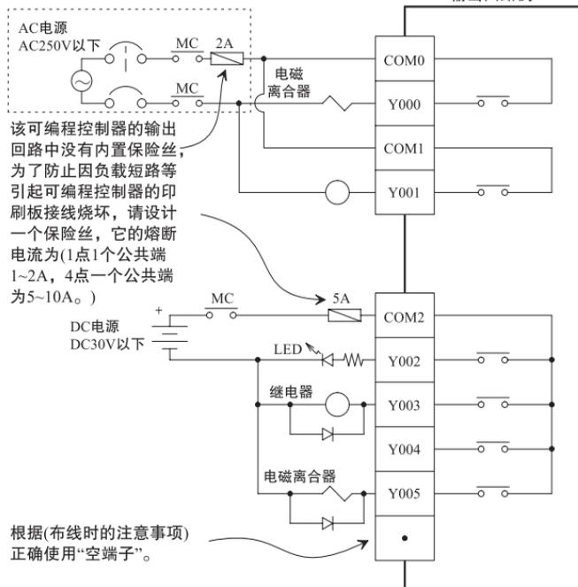
该可编程控制器的输出回路中没有内置保险丝, 为了防止因负载短路等引起可编程控制器的印刷板接线烧坏, 请设计一个保险丝, 它的熔断电流为(1点1个公共端1~2A, 4点一个公共端为5~10A。)
