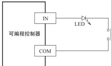
该可编程控制器的输入电流为 DC24V、7mA(X010 以后是 5mA)。输入设备请使用适合这个微弱电流的小型开关。
