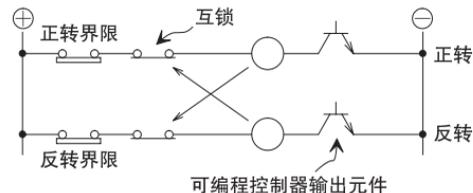
正反转接触器同时合上十分危险，象这样的负载，除了可编程控制器内部程序设定互锁以外，在可编程控制器外部也必须设置如上图所示的互锁。
