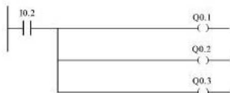
图 1-23 PLC 多个软线圈可并联输出
