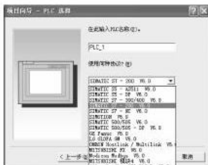
图 6-22 选择 SIMATIC S7-200 示意图
