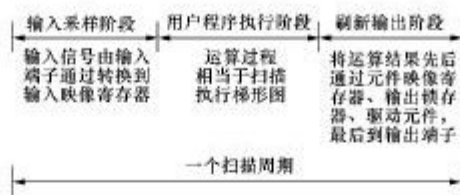
图 1-17 PLC 扫描的三个阶段示意图
