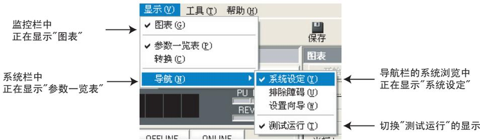
点击当前显示项目上的打勾标记，将其取消，可关闭当前显示画面。当[导航(N)]菜单中的系统浏览画面上的打勾标记被取消时，导航栏会被隐藏。
