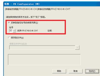
11) 确认已经选择 [ 反映到指定站号的参数列表 ] 后, 点击 **完成**, 将已经转换的参数设置反映到参数列表。站号中未进行机种设置时, 则无法选择。
