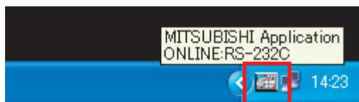
可通过图标的显示状态来确认FR Configurator的在线和离线。
