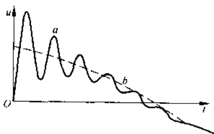
图 1-46 振荡形操作冲击电压波
