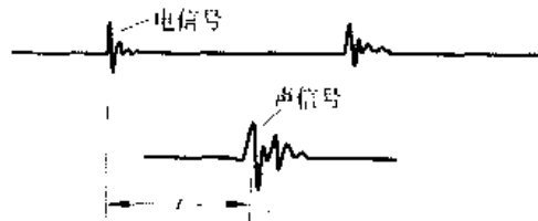
图 10-12 声波时延 t 的确定
