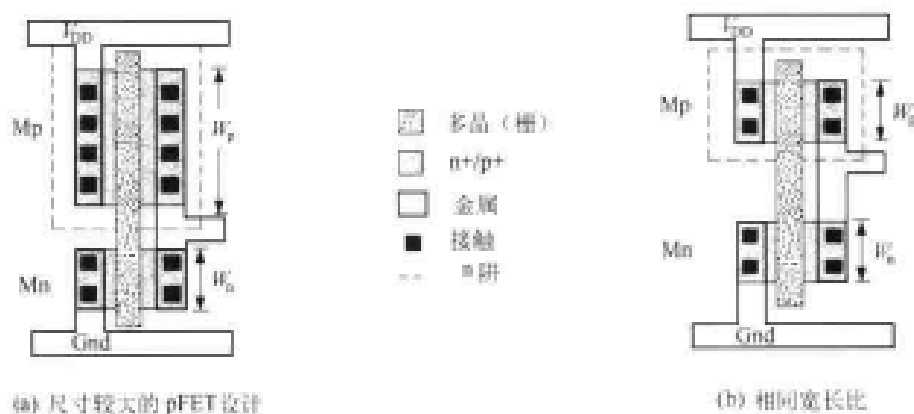
图 7.5 例 7.1 中两种设计的版图比较
