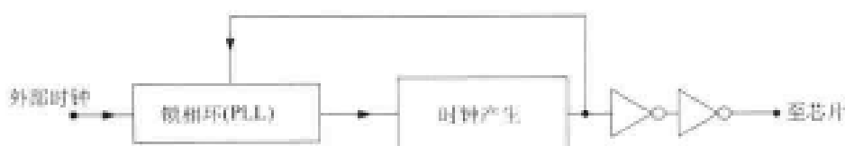
图 15.36 锁相环(PLL)时钟稳定电路
