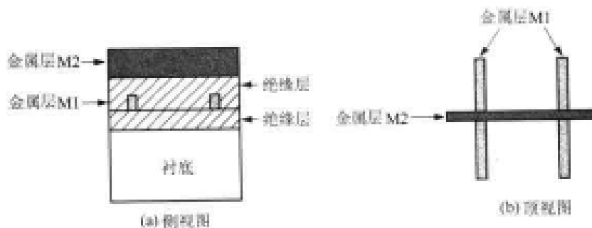
图 3.3 加上另一层绝缘层和第二层金属层
