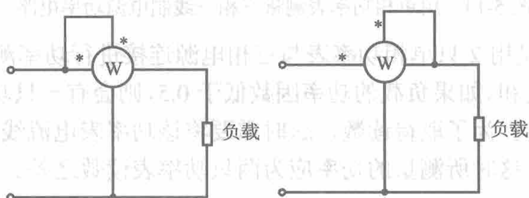
图 5-12 用单相功率表测量单相交流电的两种电路图
