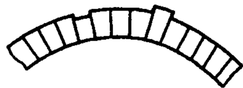
图 2-29 换向片的凸片或变形示意
