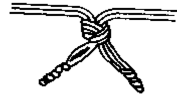
图 2-66 导线中间接头防拉断措施
