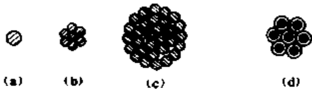
图 4-6 导线结构形式断面图
