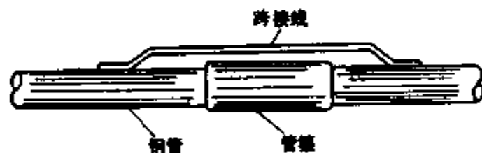
图 2-40 线管连接处的跨接线
