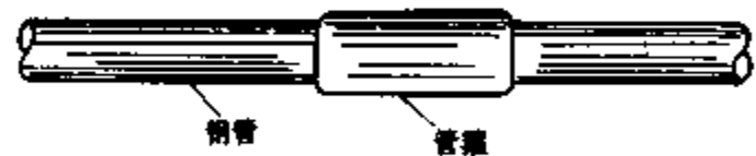
图 2-36 管箍连接钢管
