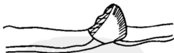
图 1-7 并焊焊头 形状示意图
