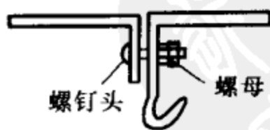
图 2-59 用螺 钉旋紧挂脚
