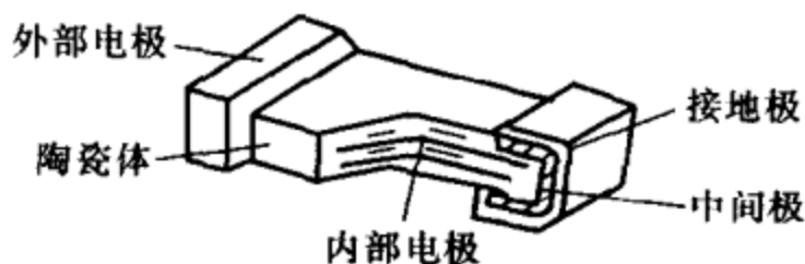
图 1-26 贴片电容示意图
