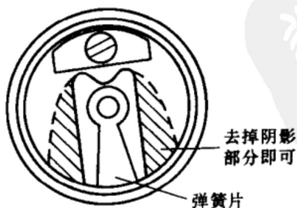
图 3-30 螺口灯头改进示意图
