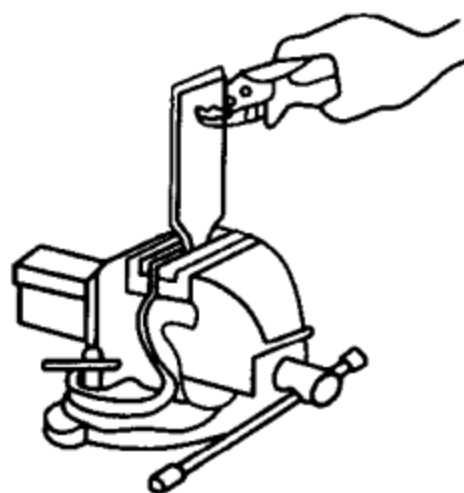
图 2-6 台虎钳上校正风叶叶脚
