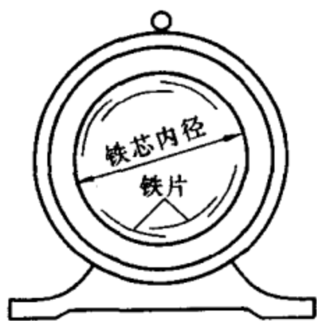
图 3-66 定子内圆贴放铁片示意图
