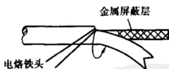
图 2-14 绝缘护套烫一圈
