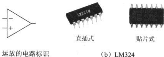
图 7-9 运算放大器的电路标识及外观
