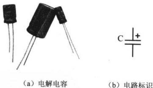
图 1-33 常用有极性电容器——电解电容
