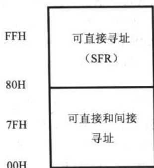
图 13-16 数据存储器结构
