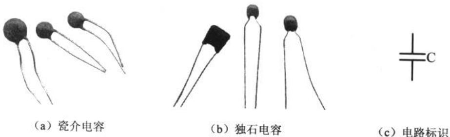
图 1-32 常用无极性电容器及其电路标识
