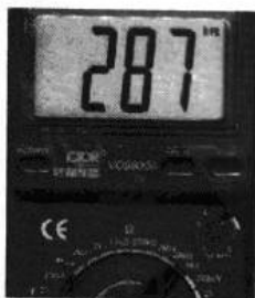
图 1-49 某支三极管 9014 的 h_{FE} 值测量结果（万用表型号：胜利 VC9805A）
