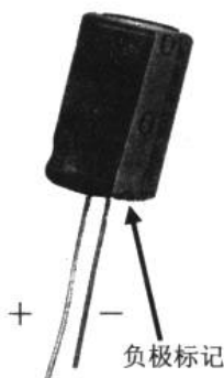
图 1-34 电解电容的极性
