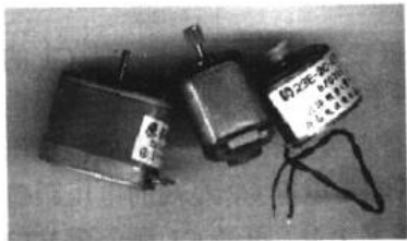
图 6-26 直流低速电机及电路标识
