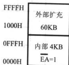
图 13-14 程序存储器结构
