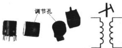
图 3-26 中频变压器（中周）及其电路标识
