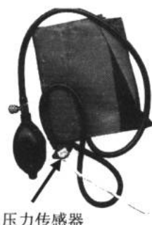
图 8-15 压力传感器与袖带的连接
