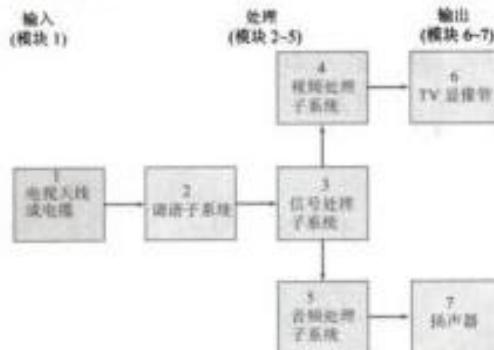
图 4-31 简化的电视系统框图
