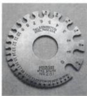
图 2-8 导线规格工具
