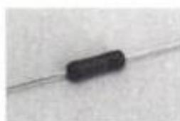
**关键特征:** 电阻值可以精确控制, 而且对温度不敏感。噪声参数和其他电子参数很好, 比一般的碳电阻稍为贵一些。
