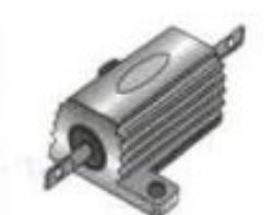
**构造:** 螺旋型的陶瓷绝缘体周围围绕一圈特殊的电阻导线, 导线的电阻系数和长度决定其电阻值。
