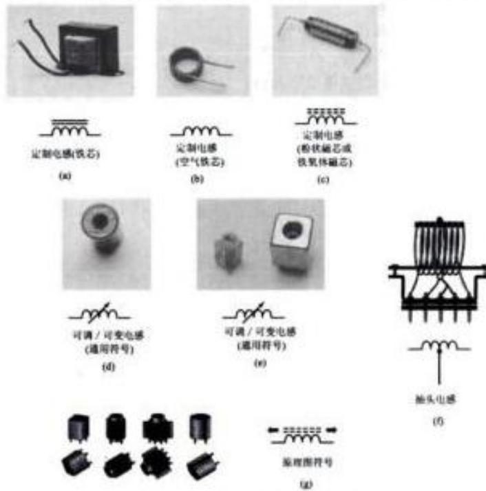
图 13-1 各种电感线圈及其符号
