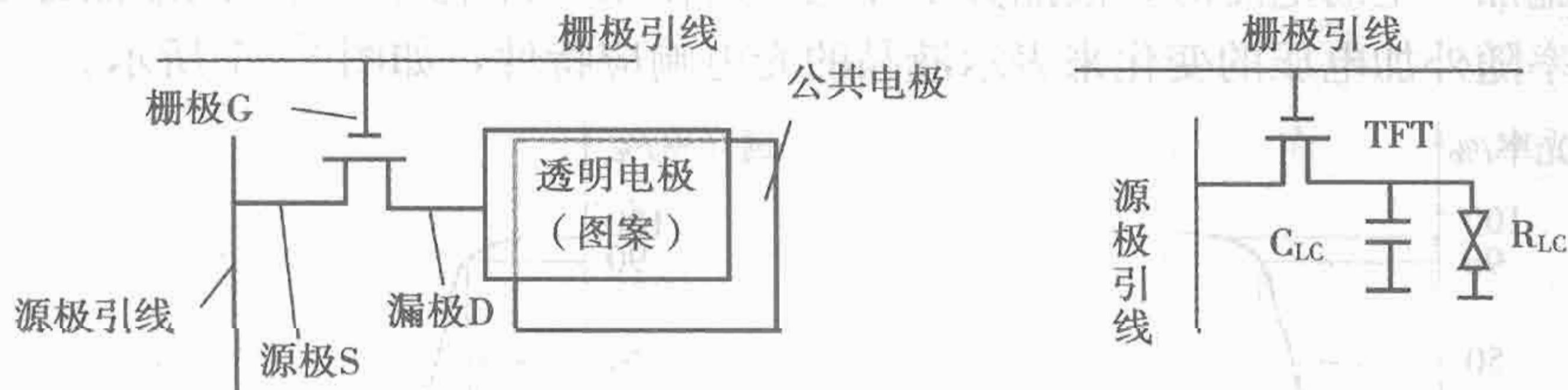
图 3—9 薄膜场效应晶体管示意图
