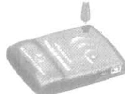
图 1.9 WDAQ100X 应力应变信号数字采集无线网络传感器
