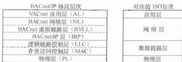
图 9.1 BACnet/IP 的完整体系结构
