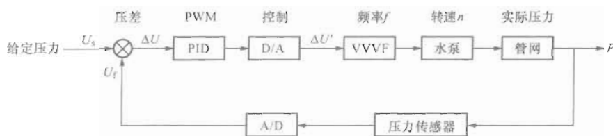
图 2.9 变频恒压供水系统的控制原理
