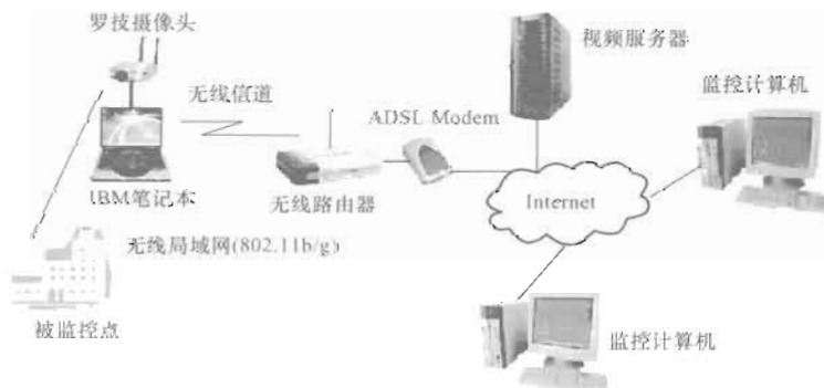
图 4.13 基于 802.11g+ADSL 模式的远程视频监控系统的组成
