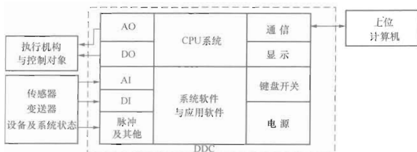
图 1.13 DDC 控制器的基本组成
